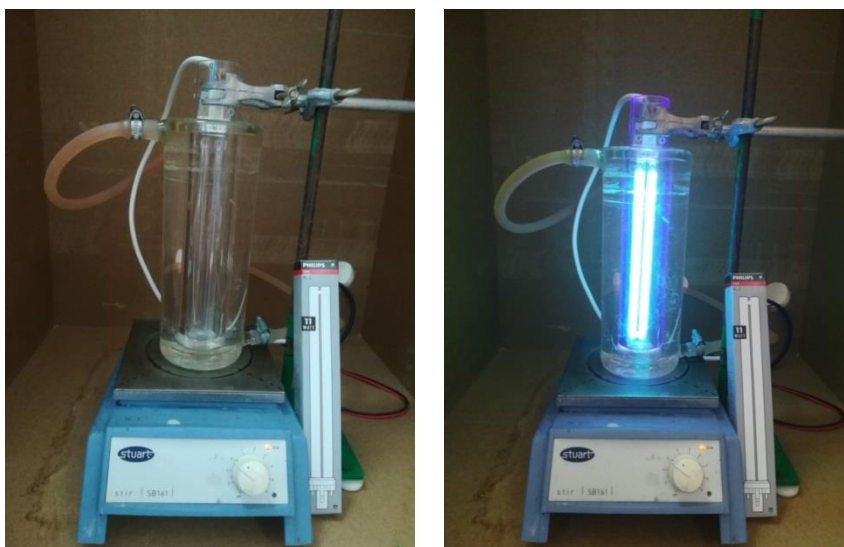
Εικόνα 3.1. Φωτογραφία του φωτοχημικού αντιδραστήρα διαλείποντος έργου, που χρησιμοποιήθηκε, με τη λάμπα εκτός λειτουργίας (a), και τη λάμπα σε λειτουργία (b).
