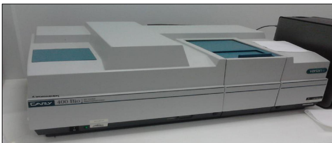
Εικόνα 7: Φασματοφωτόμετρο διπλής δέσμης του οίκου Varian (Cary 400 UV/Vis Spectrophotometer).
