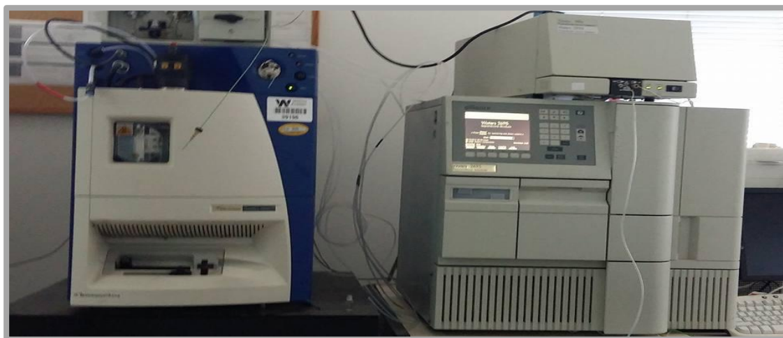
Εικόνα 4: Σύστημα υγρής χρωματογραφίας υψηλής απόδοσης (Waters Alliance 2695), ανιχνευτής συστοιχίας φωτοδιοδών (Waters 2996, Photodiode Array), ανιχνευτής μάζας (triple quadrupole Quattro micro MS, Waters-Micromass).
