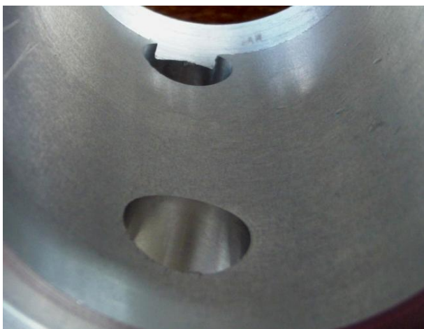
Σχήμα 4.5: Εσωτερικό κυλινδρικού αποστάτη μετά την επιδιόρθωση
