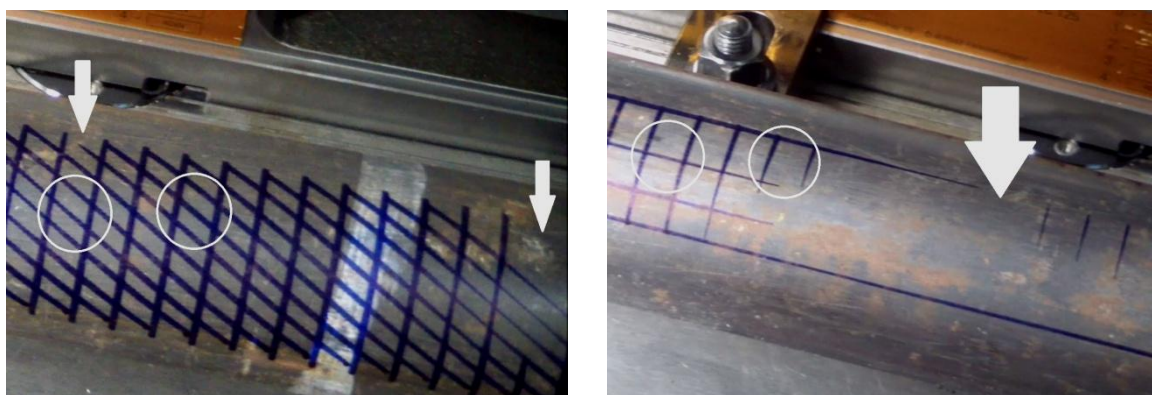
Σχήμα 4.22: Σφάλματα λόγω εκκεντρότητας και χτυπημάτων των αυλών. Αριστερά χάραξη Oblique Fins, δεξιά χάραξη Chessboard.
