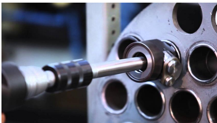
Σχήμα 2.7: Διαστολέας αυλών αριστερά (προσφορά της Honiron manufacturing), τομή παραμορφωμένου αυλού δεξιά [9]
