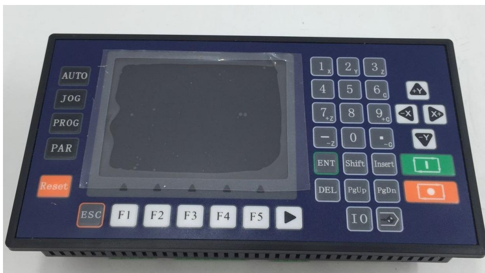
Σχήμα 3.6: Χειριστήριο TOPCNC TC55V (προσφορά της fasttobuy.com)
