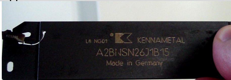
Σχήμα 4.30: Εργαλείο αυλακώσεων 1,4 mm και μανέλα Kennametal
