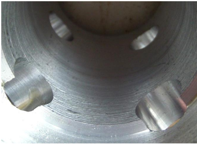
Σχήμα 4.4: Εσωτερικό κυλινδρικού αποστάτη (παρουσιάζει εμφανή σημάδια τριβής)
