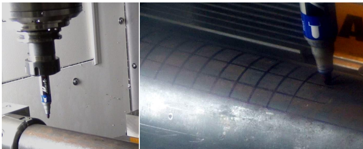
Σχήμα 4.16: Προσομοίωση χαράξεων με μαρκαδόρο
