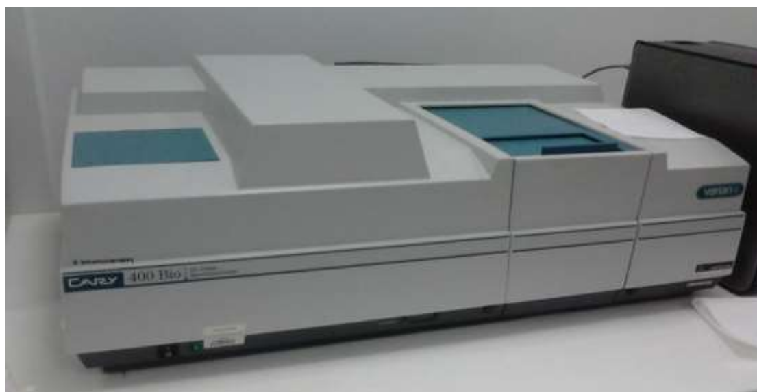
Εικόνα 3.6. Φασματοφωτόμετρο διπλής δέσμης του οίκου Varian (Cary 400 UV/Vis Spectrophotometer).
