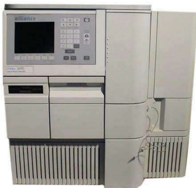
Εικόνα 3.4. Υγρός χρωματογράφος τύπου Alliance 2996
