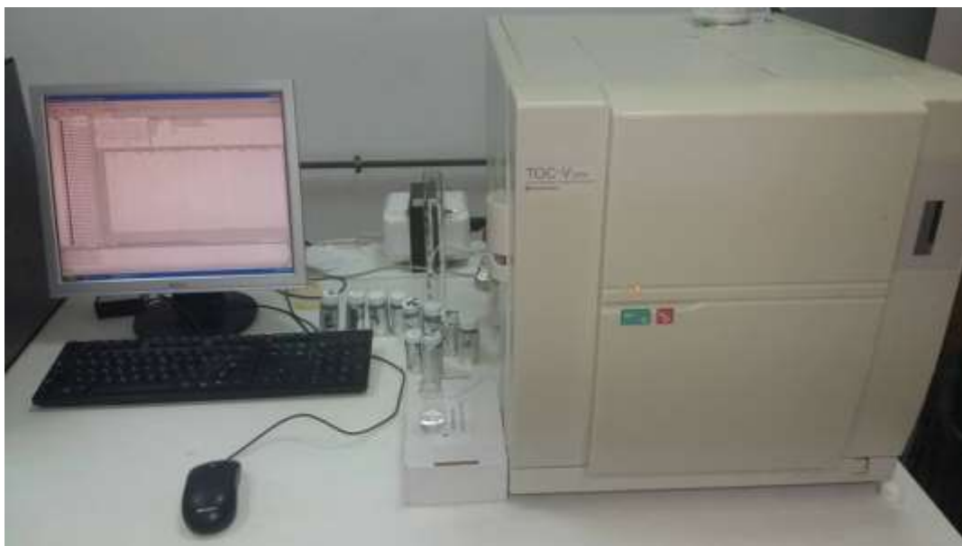
Εικόνα 3.5. Αναλυτής οργανικού άνθρακα
