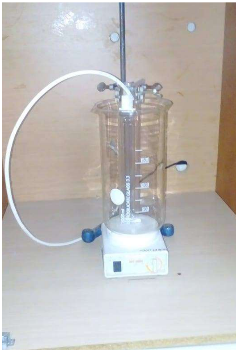
Εικόνα 3.3. Εργαστηριακός φωτοχημικός αντιδραστήρας διαλείποντος έργου 2 L
