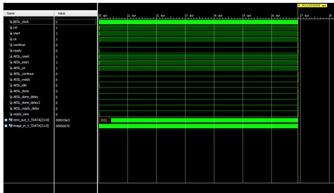
Σχήμα 4.1: Simulation Sum of Absolute Differences για εικόνα διαστάσεων 320x240 και πρότυπο 16x16
