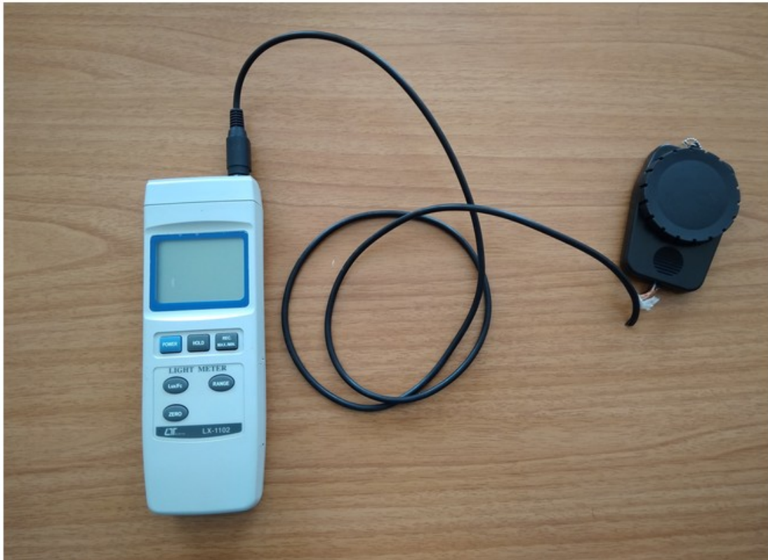
Σχήμα 6.3: Lightmeter LX-1102 για τη μέτρηση της ηλιακής ακτινοβολίας.
