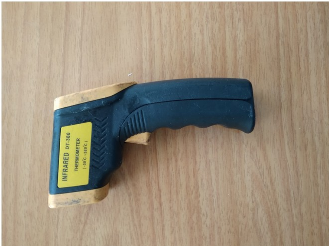
Σχήμα 6.4: Θερμόμετρο για τη μέτρηση θερμοκρασίας του φωτοβολταϊκού.
