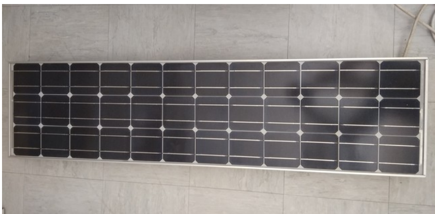
Σχήμα 6.1: Μπροστινή όψη φωτοβολταϊκού 36 φωτοβολταϊκών στοιχείων.
