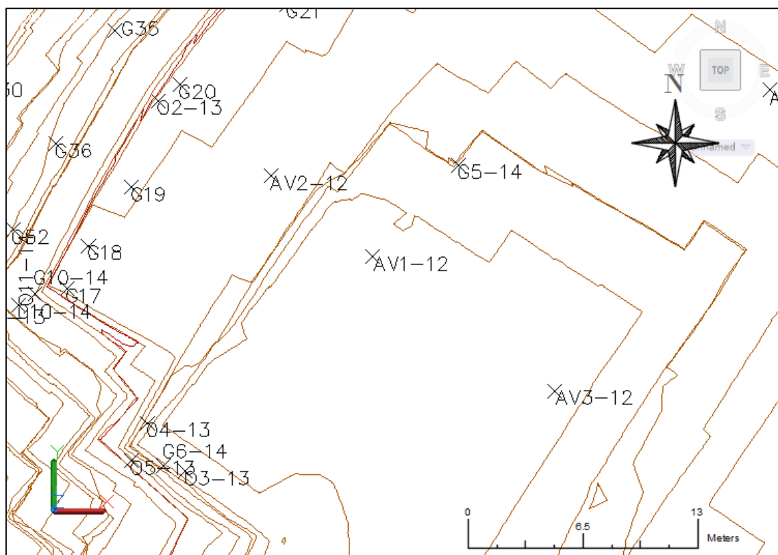
Σχήμα 2. 3: Επιφάνεια εργασίας AutoCAD™ κατά την εισαγωγή των σημείων των γεωτρήσεων στο τοπογραφικό.
