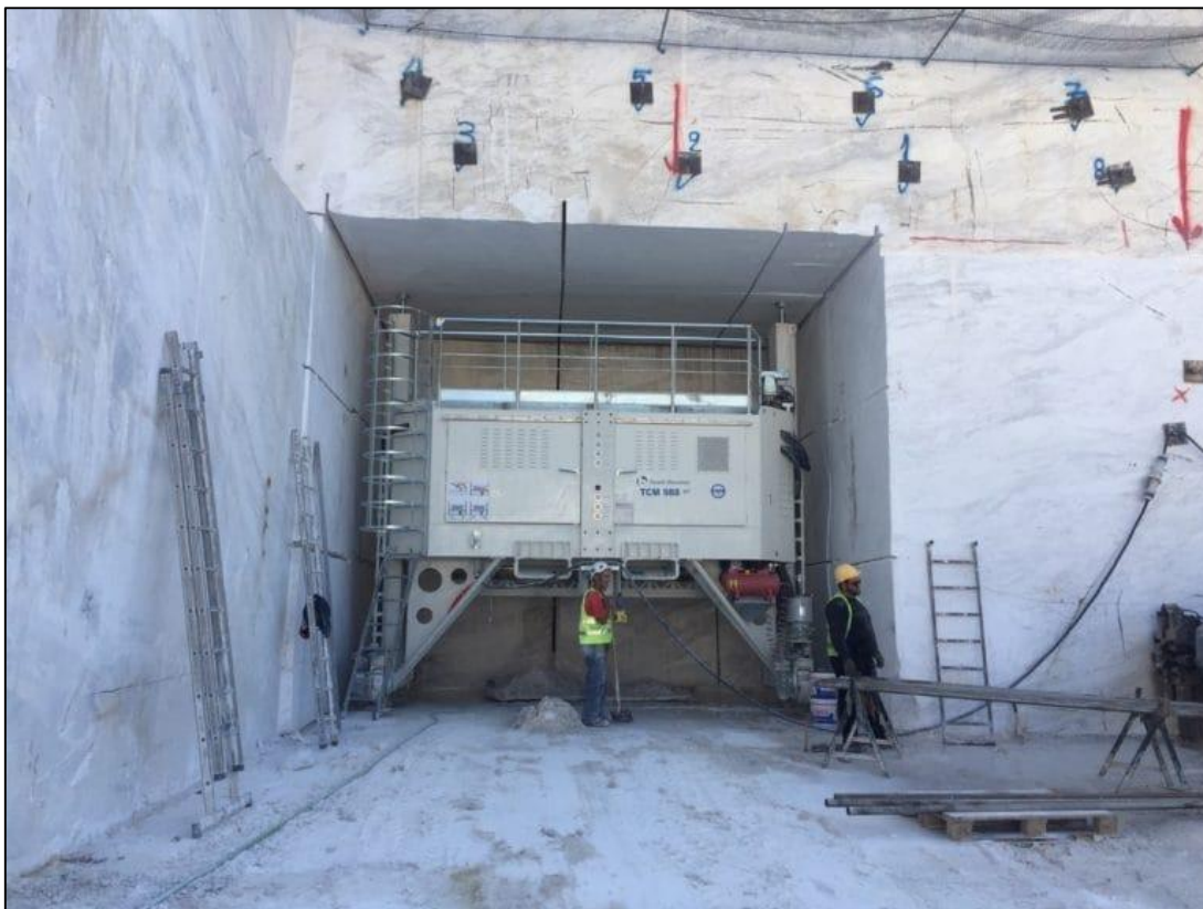
Σχήμα 1. 10: Φωτογραφία από την έναρξη εξόρυξης στοάς στον κάτω υπόγειο θάλαμο σε υψόμετρο 1158m (Βώλακας, ΙΚΤΙΝΟΣ ΕΛΛΑΣ Α.Ε.)
