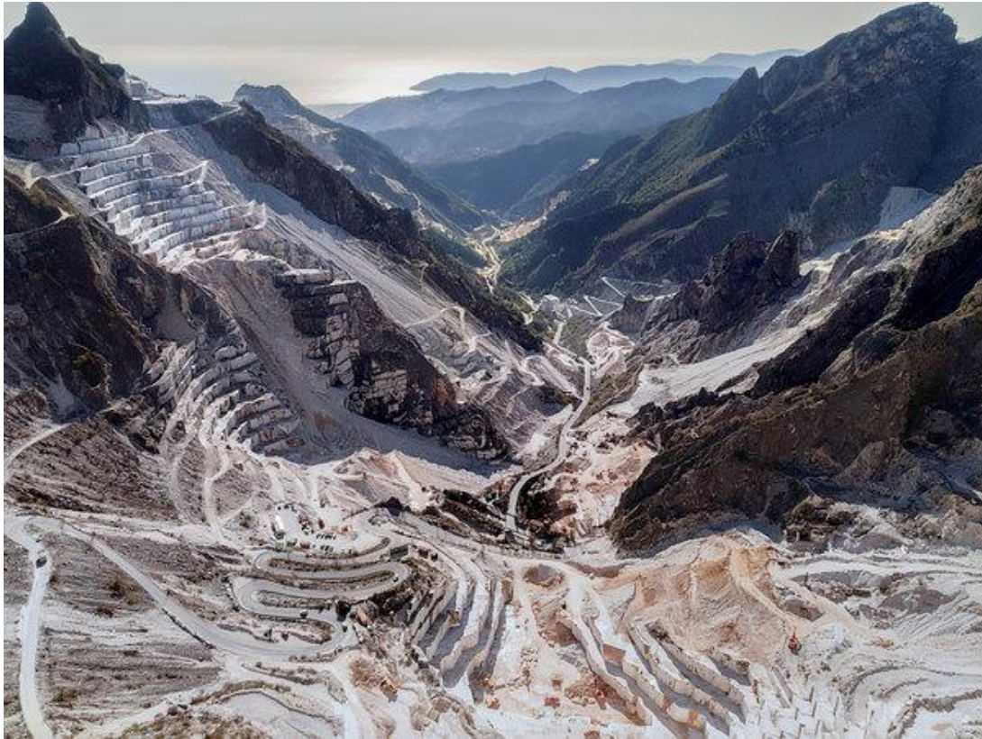
Εικόνα 12 Εκμετάλλευση με ανοιχτές βαθμίδες. Λατομείο μαρμάρου που βρίσκεται στη περιοχή Carrara της Ιταλίας.
