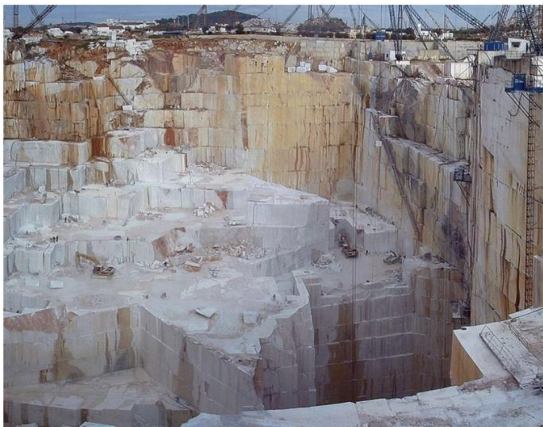
Εικόνα 11 Υπαίθρια εκμετάλλευσης με κατακόρυφα τοιχώματα μορφής φρέατος (ή βαθιάς τάφρου) σε αρχικά επίπεδο τοπογραφικό ανάγλυφο (Πορτογαλία).
