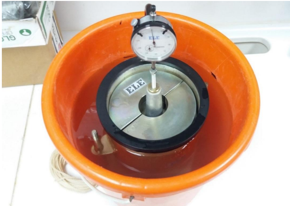
Φωτογραφία 4.5: Υδρεμποτισμός κατά την διάρκεια της δοκιμής CBR.
