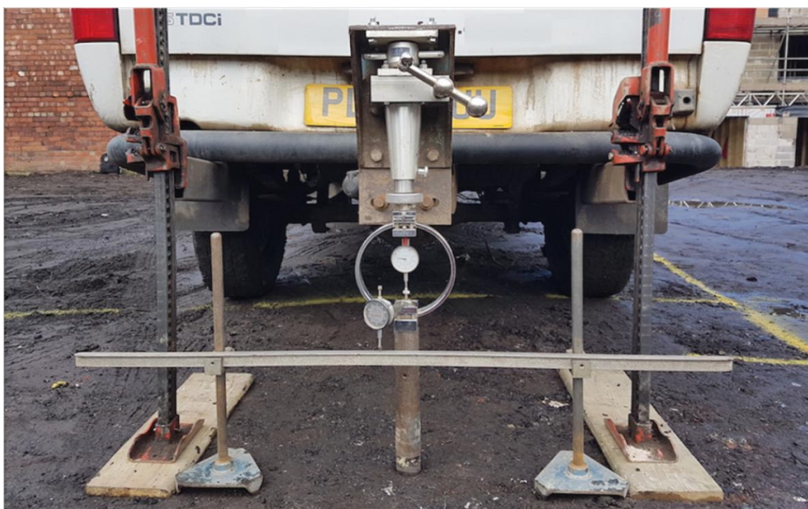
Φωτογραφία 2.1: Επί τόπου δοκιμή CBR ( www.subsurface.co.uk ).
