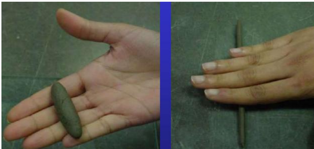
Φωτογραφία 4.3: Μορφοποίηση ραβδίσκου για τον προσδιορισμό του ορίου πλαστικότητας.
