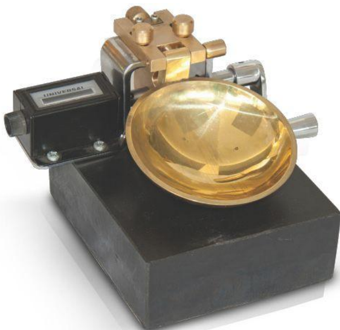
Φωτογραφία 4.2: Συσκευή Casagrande για τον προσδιορισμό του ορίου υδαρότητας.
