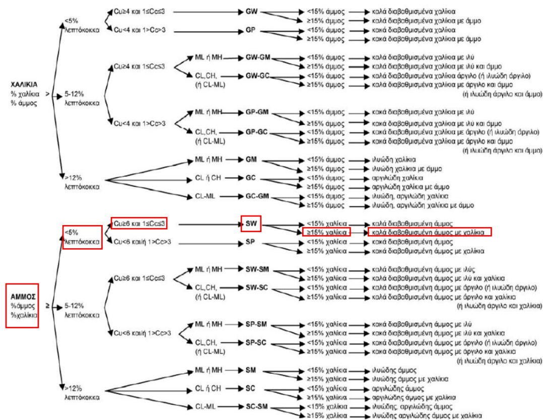
Σχήμα 4.11: Διάγραμμα ροής για την ταξινόμηση χονδρόκοκκου εδάφους (περισσότερο από 50% συγκρατείται στο κόσκινο No. 200).
