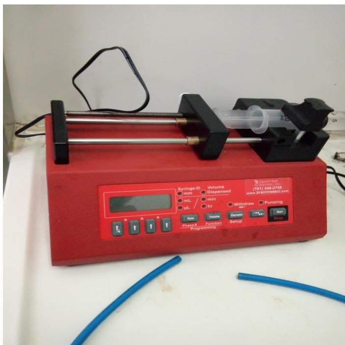
Εικόνα 8 α) Συσκευή παροχής ατμού, β) σωληνάκια σύνδεσης, γ) σύριγγα που περιέχει απιονισμένο νερό σε υγρή μορφή.
