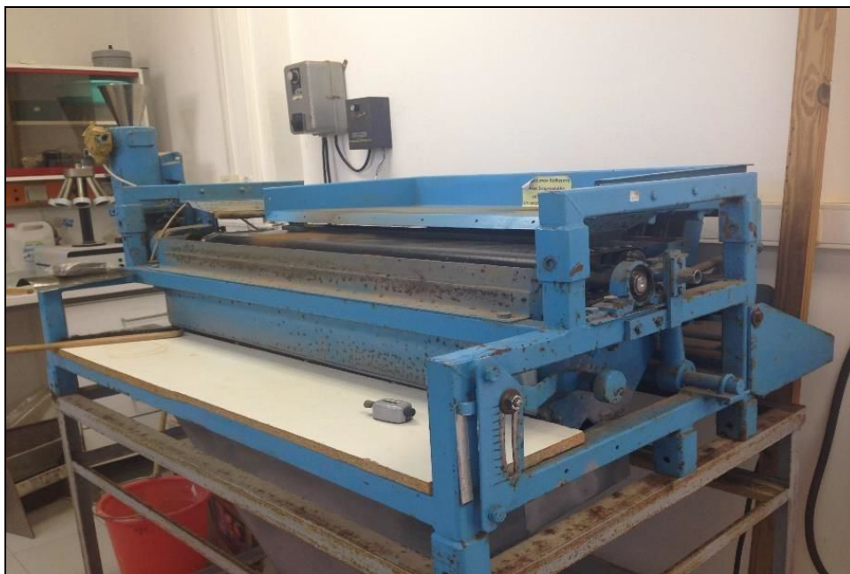
Εικόνα 4.1: ταινιοφόρος μαγνητικός διαχωριστής (Perm Roll).
