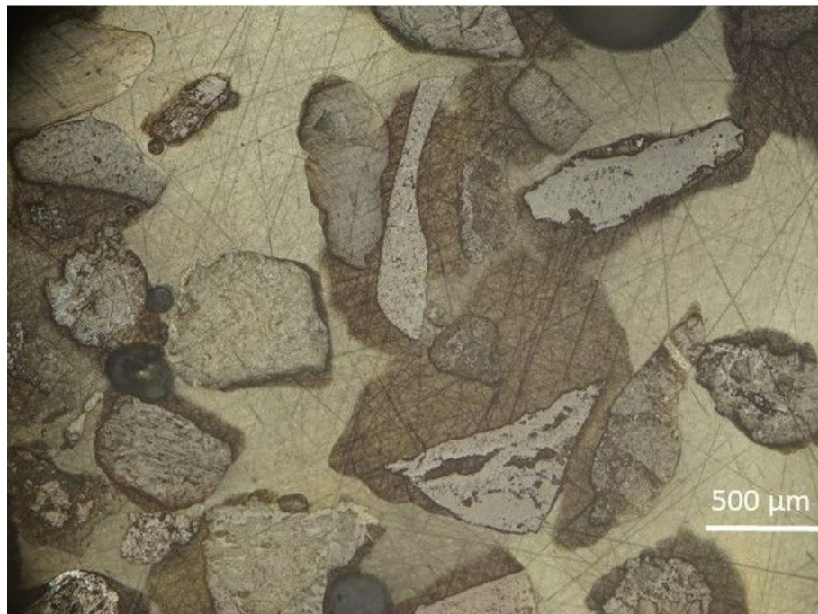
Εικόνα 7.4.4: Δείγμα α3MM ( -1+0.250 , μη μαγνητικό). Κόκκοι πυριτικού συνδετικού υλικού και κόκκοι χαλαζία.
