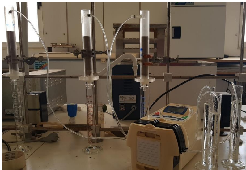
Εικόνα 22: Δοκιμές στηλών, Στήλες- Αντλία.
