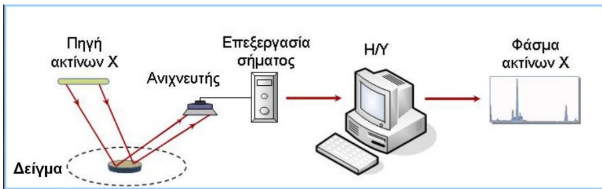
Εικόνα 15: Μέθοδος φθορισμού ακτίνων-Χ.
