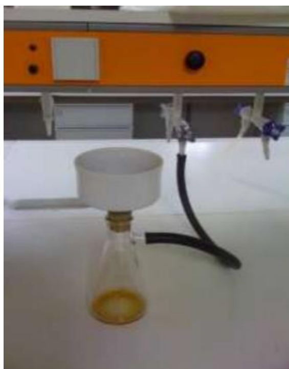
Εικόνα 21: Διήθηση υπό κενό.
