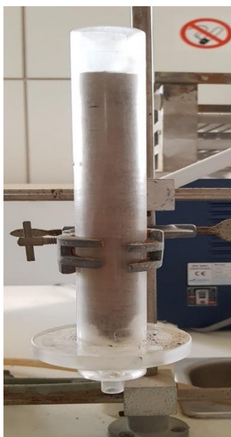
Εικόνα 23: Στήλη από Plexiglas του εργαστηρίου Γεωχημείας.
