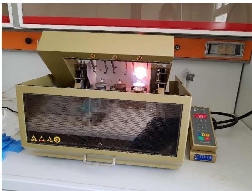
Εικόνα 18: Δημιουργία υαλοποιημένων δισκίων στη συσκευή τήξης τύπου Claisse M4.
