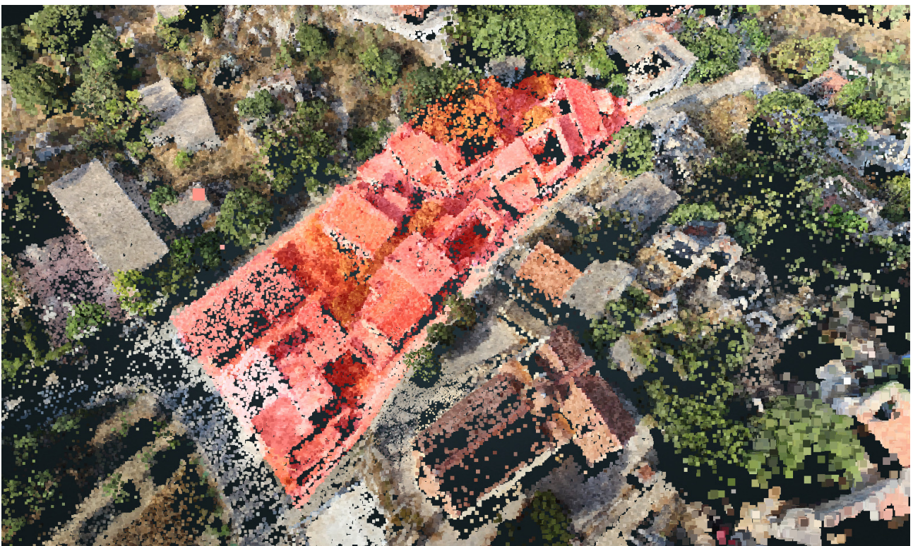
Εικ. 5.3.1.2-6α: Το εργαλείο Clipping του μενού Tools με “Polygon Clip” με: Highlight
