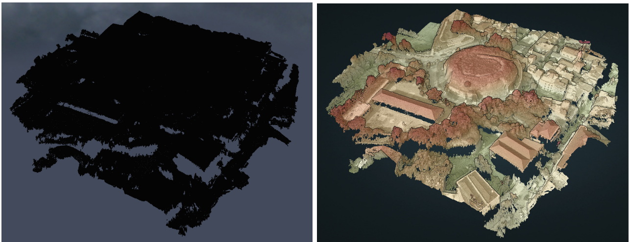
Εικ. 5.3.1.3-10: Point cloud του Προμαχώνα Lando ή Schiavo ή Αγίου Δημητρίου, Χανιά αριστερά: χωρίς επεξεργασία, δεξιά: με EDL on & Composite για RGB, Intensity, Elevation
