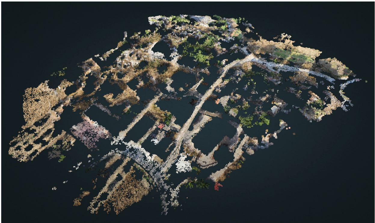
Εικ. 5.3.2.2-4: Αυτοματοποιημένη ταξινόμηση σημείων εδάφους από το εργαλείο “Ground Classification” σε point cloud του Καμαριώτη. Η εμφάνιση / απόκρυψη κατηγοριών γίνεται από το μενού “Classification Filter”
