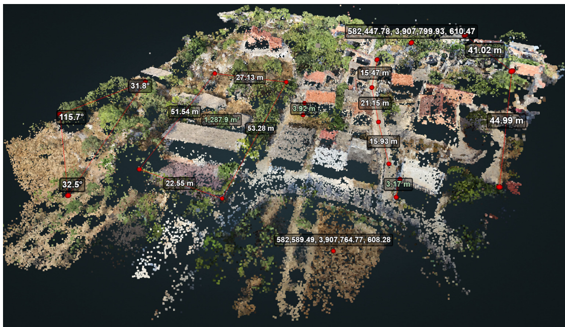
Εικ. 5.3.1.2-2: Διάφορες μετρήσεις γωνιών, σημείων, αποστάσεων, υψομετρικών διαφορών και επιφανειών σε point cloud του Καμαριώτη
