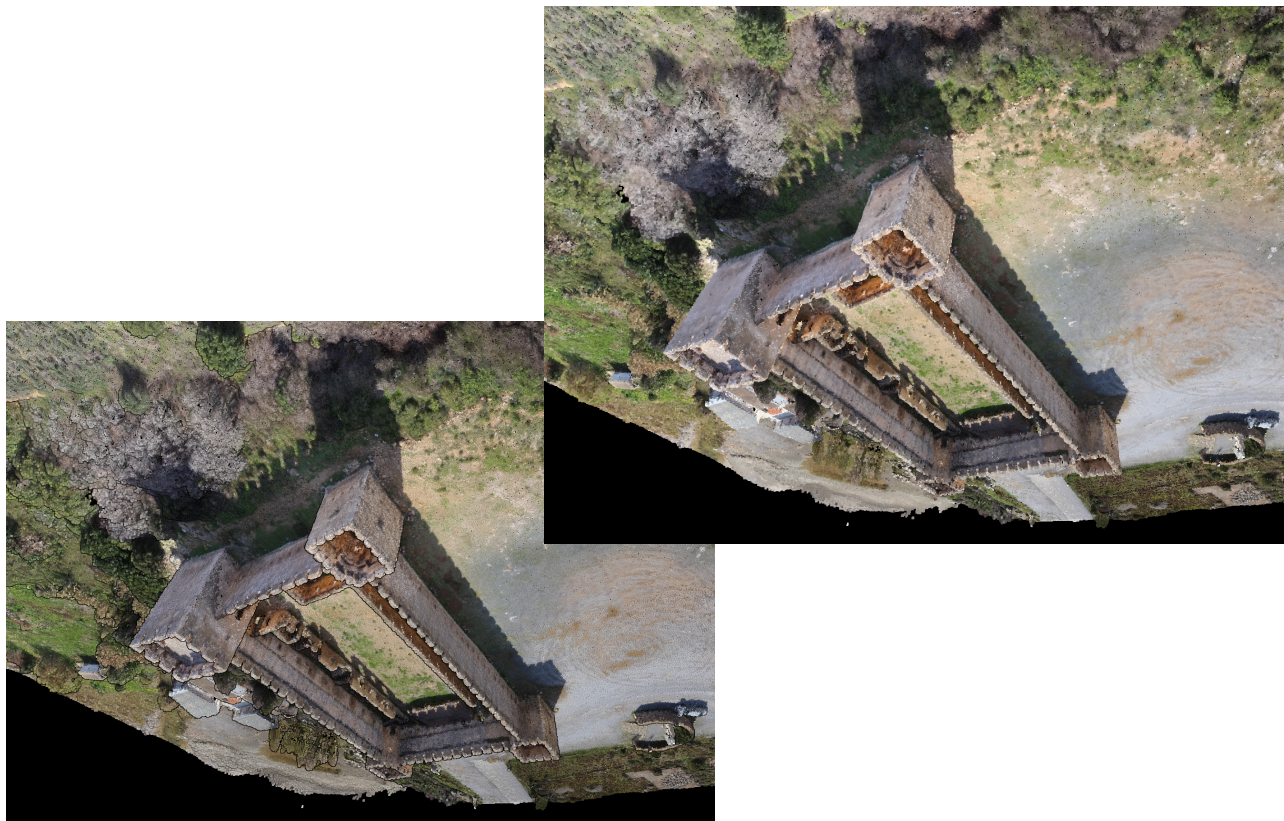
Εικ. 5.3.1.3-12: Point cloud του Φραγκοκάστελλου, επάνω: χωρίς επεξεργασία, κάτω: με EDL on τονίζονται οι ακμές και οι υψομετρικές διαφορές των αντικειμένων
