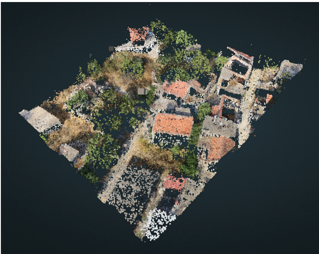
Εικ. 5.3.2.2-2: Τμήμα point cloud του Καμαριώτη που έχει προκύψει από αποκοπή με χρήση του εργαλείου “Crop”
