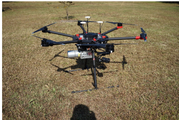
Εικ. 1.1.4-1: UAV (Unmanned Aerial Vehicle) με προσαρμοσμένο αισθητήρα LiDAR από: https://enterprise.dji.com/news/detail/how-lidar-is-revolutionizing-mapping-and-geospatial-data
