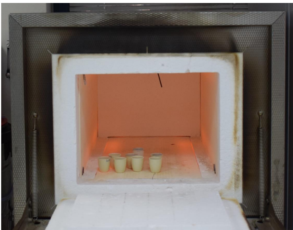
Εικόνα 19. Μέτρηση τέφρας των εξανθρακωμάτων
