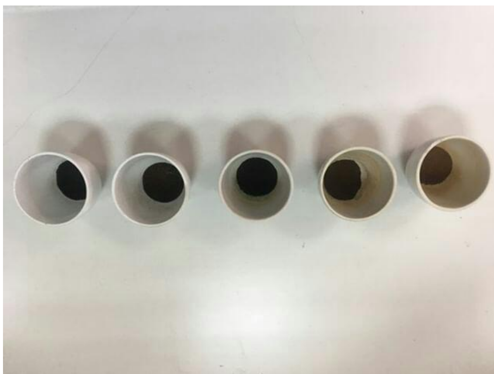
Εικόνα 18. Προετοιμασία δειγμάτων για μέτρηση τέφρας
