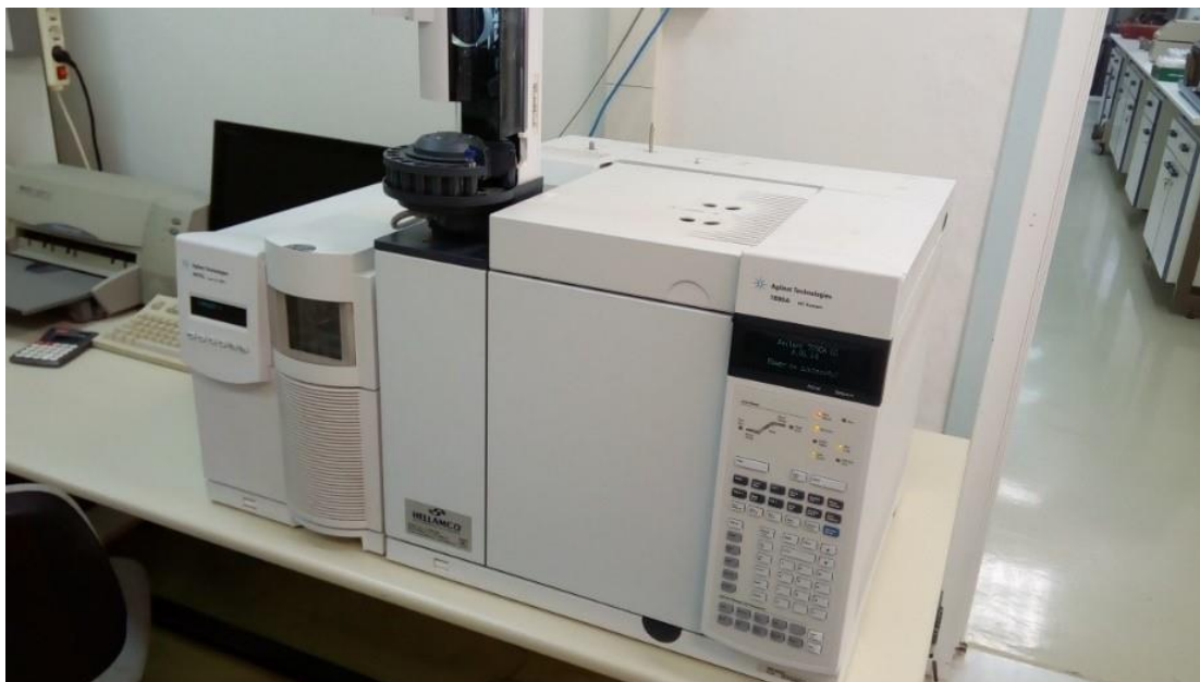
Εικόνα 4.5: GC/MS 7890A της Agilent Technologies (αέρια χρωματογραφία-φασματομετρία μάζας).
