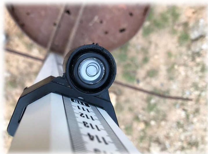
Σχήμα 6.6: Αεροστάθμη οριζοντίωσης σταδίας
