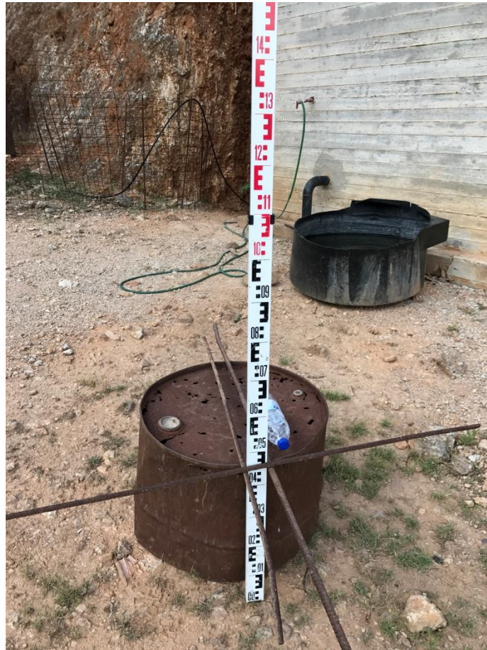
Σχήμα 6.5: Βαθμολογημένος κανόνας (σταδία)
