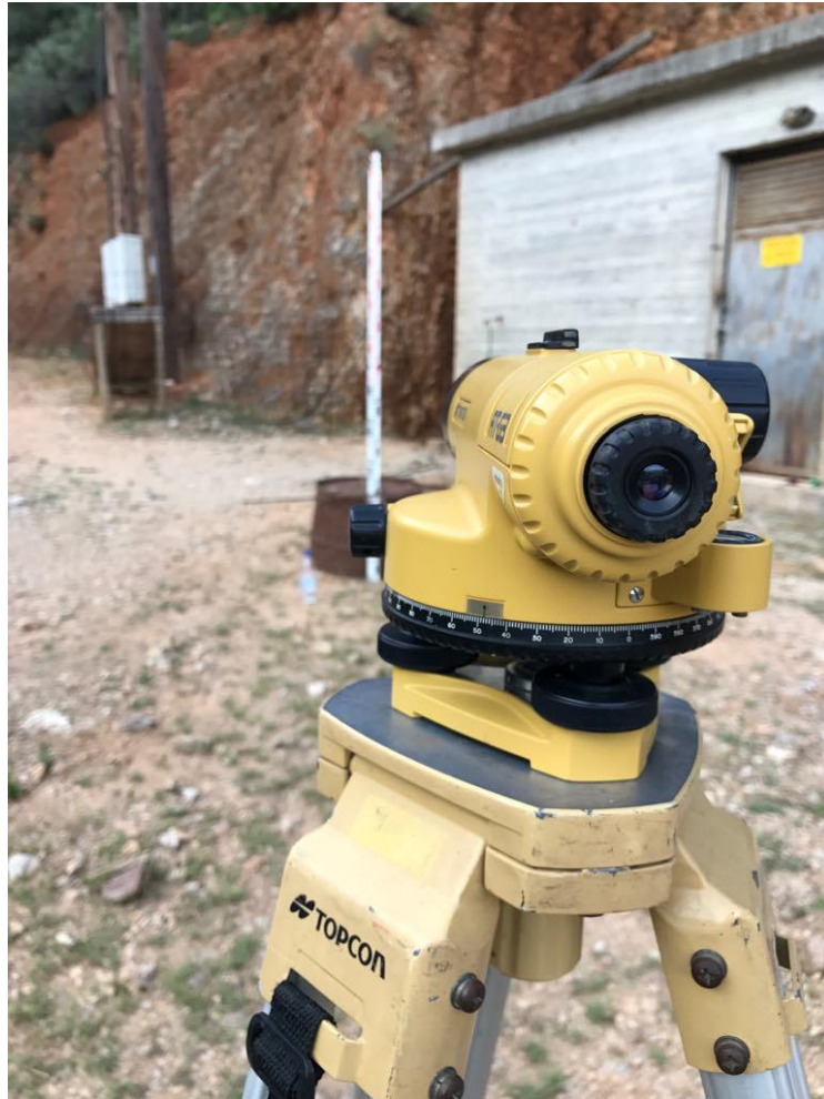
Σχήμα 6.4: Οριζοντιόμενος χωροβάτης.
