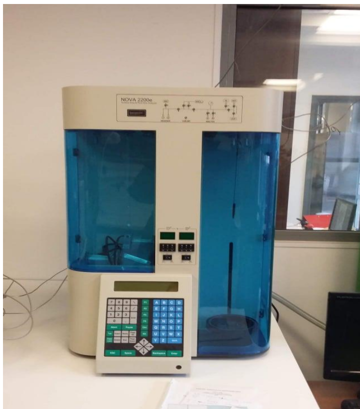
Εικόνα 3.2 Η συσκευή 2200e Nova(Quantachrome).
