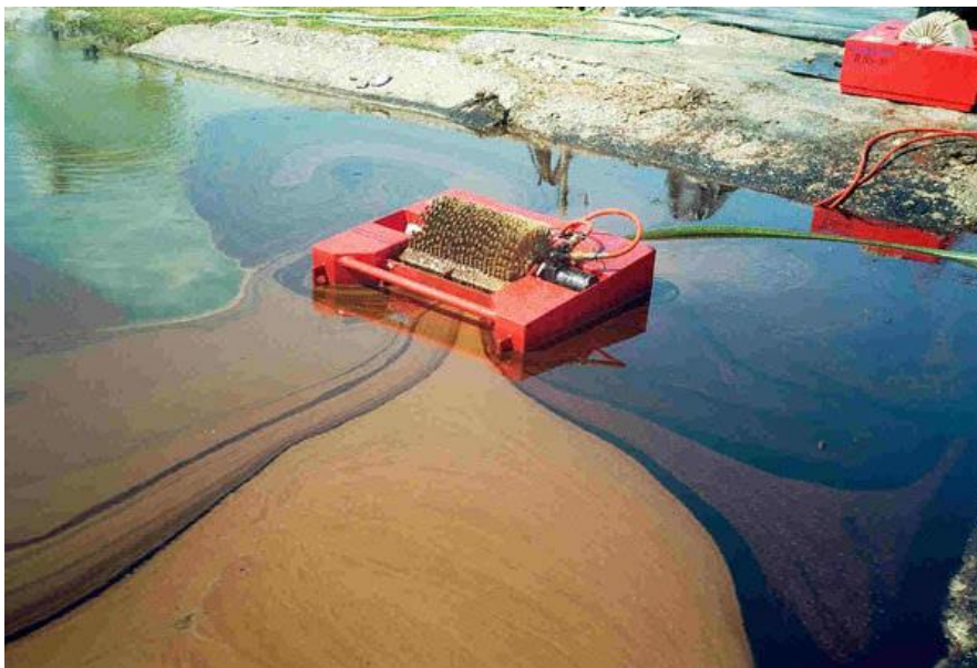
Εικόνα 6 Χρήση Skimmer για ανάκτηση πετρελαίου, Πηγή: canacoregdl.com
