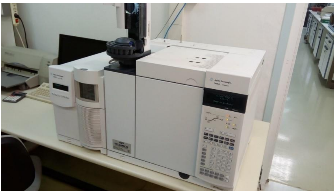
Εικόνα 25: GC/MS 7890A της Agilent Technologies (αέρια χρωματογραφία-φασματοσκοπία μάζας)
