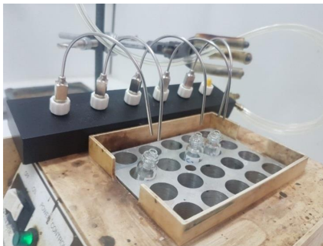
Εικόνα 23 Εργαστηριακή διάταξη για την συμπύκνωση των δειγμάτων
