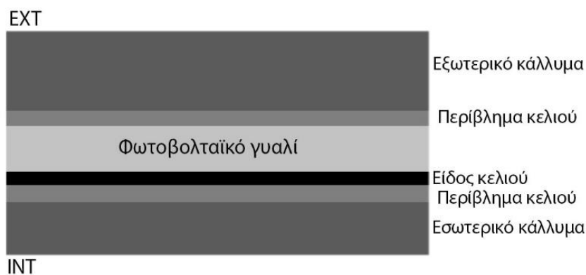
Εικόνα 1.6: Δομή Thin Film PV.
