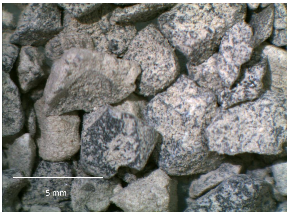
Σχήμα 4.12. Κόκκοι άμμου μετά από αυτογενή λειοτρίβηση (RCA2) χωρίς τη χρήση ραβδόμυλου.
