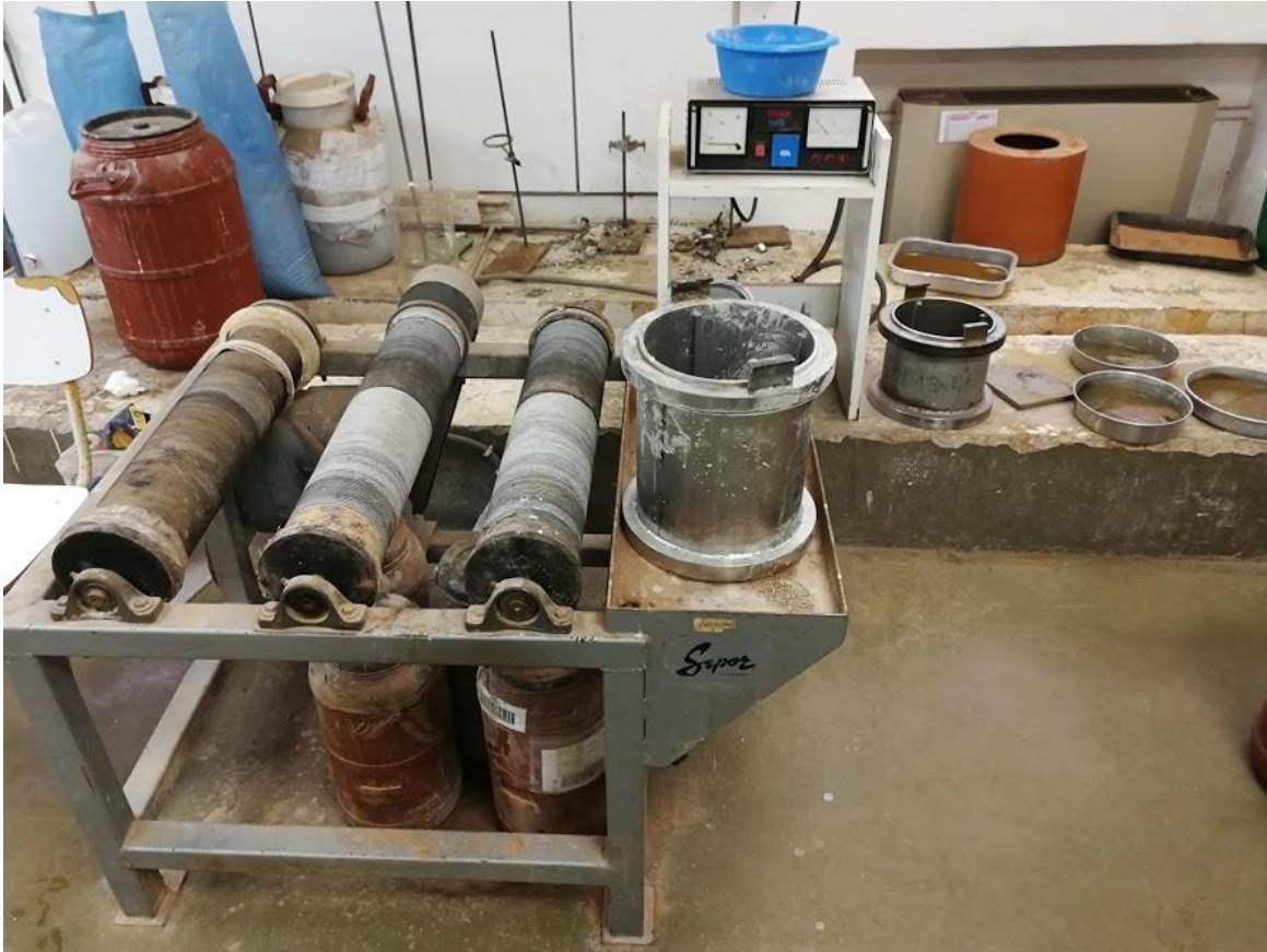
Σχήμα 4.1. Περιστρεφόμενος εργαστηριακός μύλος που χρησιμοποιήθηκε για την αυτογενή λειοτρίβηση.
