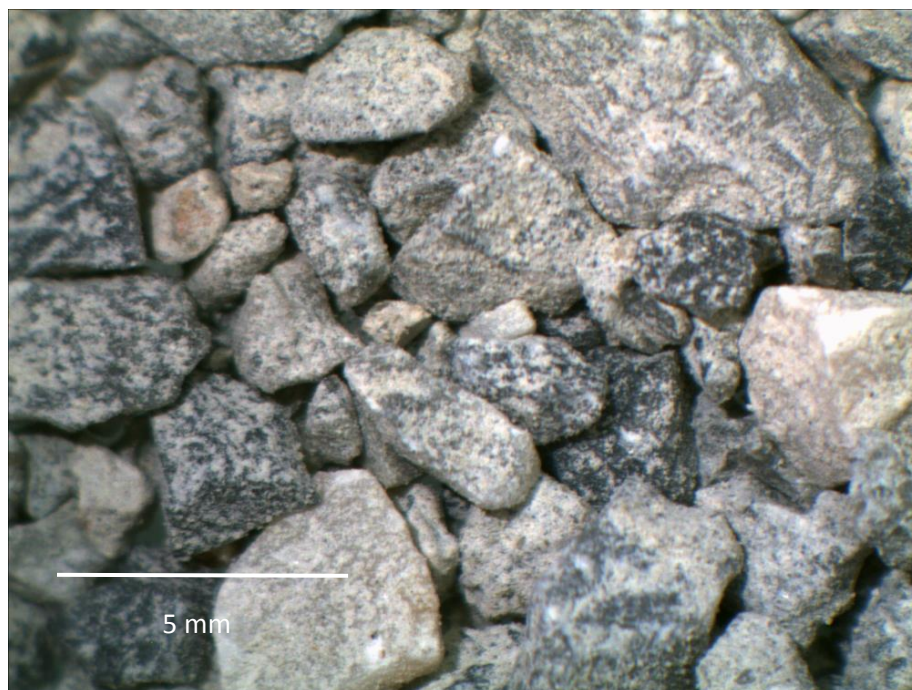
Σχήμα 4.13. Κόκκοι άμμου με αναβάθμιση ενός σταδίου (RCA1) με τη χρήση ραβδόμυλου για 180s.
