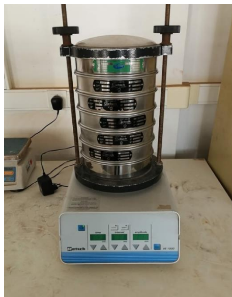
Σχήμα 3.3. Μηχανή κοσκίνισης και κόσκινα της εταιρείας Retsch.
