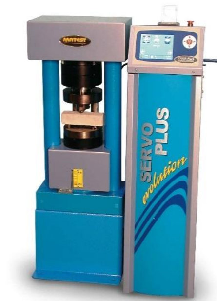
Σχήμα 5.1. Μηχανή μέτρησης αντοχής σε μονοαξονική θλίψη και κάμψη.
