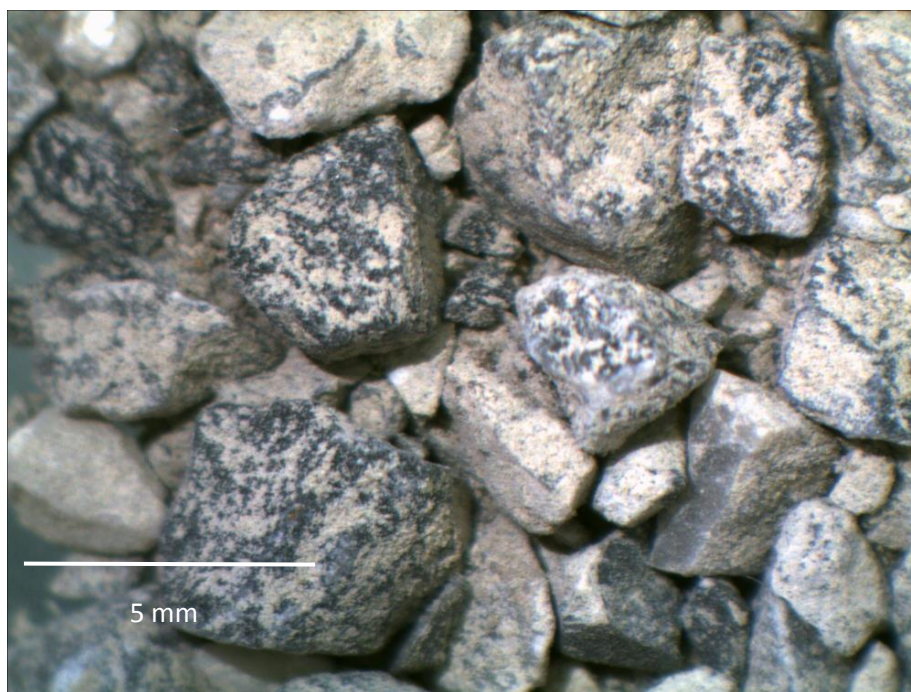
Σχήμα 4.15. Κόκκοι άμμου χωρίς καμία αναβάθμιση (RCA) με χρήση ραβδόμυλου 60s.
