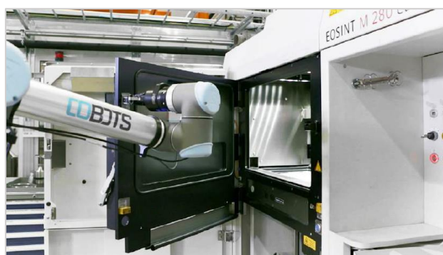
Εικόνα 47: Ρομποτικός βραχίονας αφαίρεσης της πλεονάζουσας σκόνης από το μηχάνημα M280 της εταιρίας EOS μετά την κατασκευαστική φάση [14].
