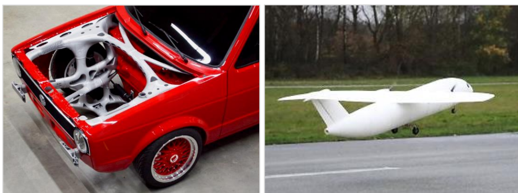
Εικόνα 11: Κατασκευή μερών εσωτερικής δομής ενός κλασικού VW Caddy (αριστερά) και το drone THOR (δεξιά) με τρισδιάστατη εκτύπωση.
