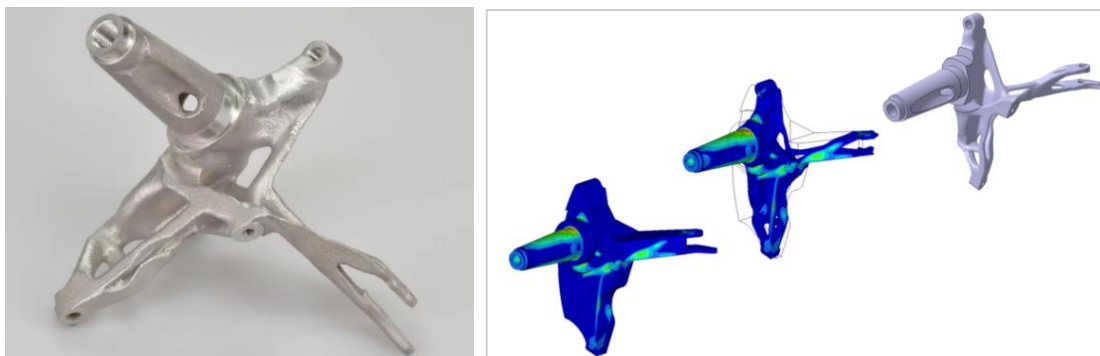
Εικόνα 30: Δομικά βελτιστοποιημένο στήριγμα τροχού (wheel bearing) για εξαιρετικά ελαφρύ όχημα (αριστερά). Ανάλυση Πεπερασμένων Στοιχείων στο αρχικό στάδιο του σχεδιασμού του στηρίγματος τροχού και αριθμητική βελτιστοποίηση του σχεδιασμού για ελαχιστοποίηση της μάζας του εξαρτήματος χωρίς να επηρεαστεί η λειτουργικότητα και σχεδιαστική απόδοση του εξαρτήματος μέσω πρότυπου αρχείου CAD (δεξιά)
