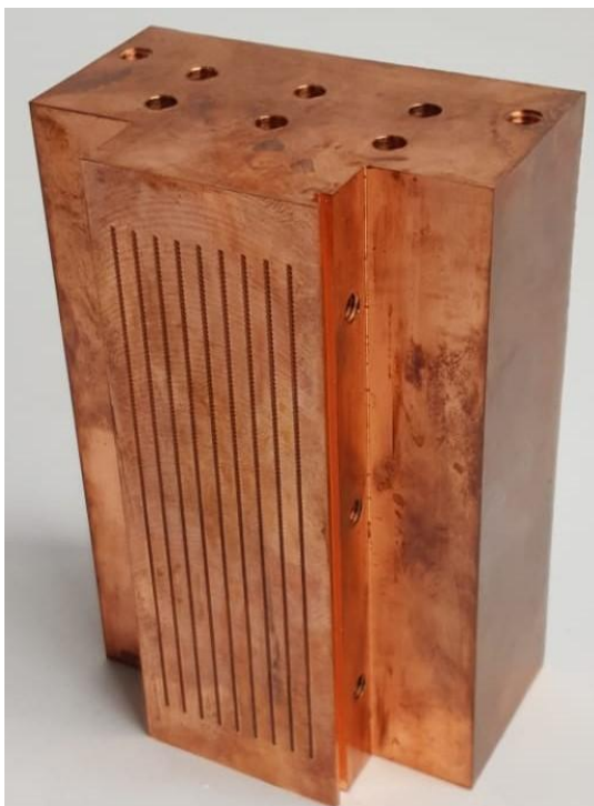
Σχήμα 4.24 : Τελικό δοκίμιο με χάραξη Zigzag
