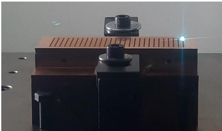
Σχήμα 4.6: Εικόνα από την διαδικασία χάραξης του δοκιμίου
