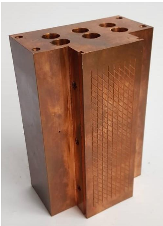
Σχήμα 4.16 : Τελικό δοκίμιο με χάραξη Oblique fins
