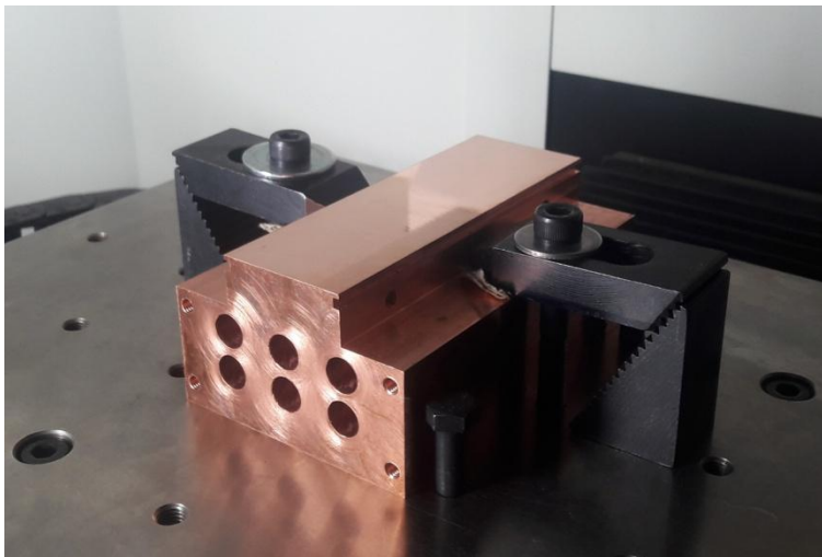
Σχήμα 4.28 : Το δοκίμιο κατάλληλα δεμένο στο τραπέζι της μηχανής προς χάραξη
