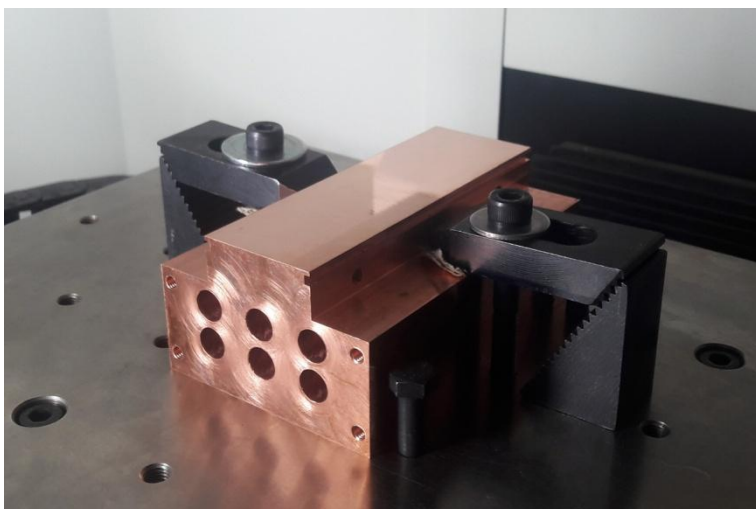
Σχήμα 4.3 : Το δοκίμιο κατάλληλα δεμένο στο τραπέζι της μηχανής προς χάραξη
