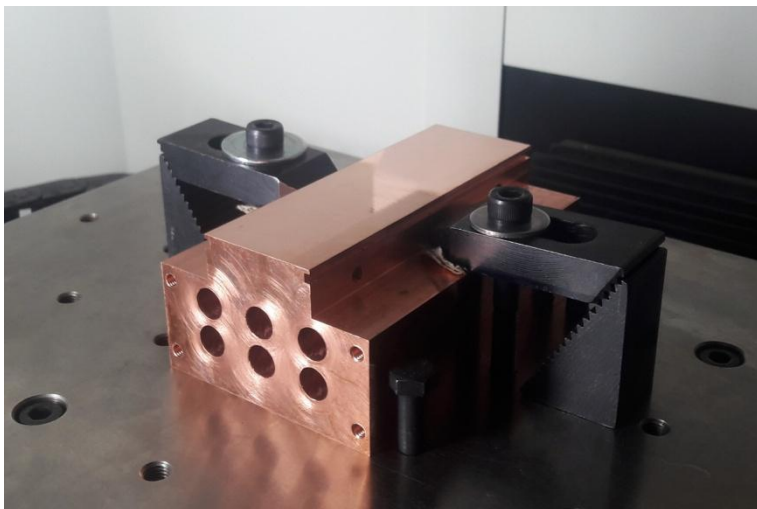
Σχήμα 4.20 : Το δοκίμιο κατάλληλα δεμένο στο τραπέζι της μηχανής προς χάραξη
