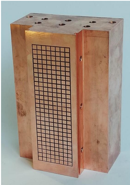
Σχήμα 4.7 : Τελικό δοκίμιο με χάραξη Chessboard
