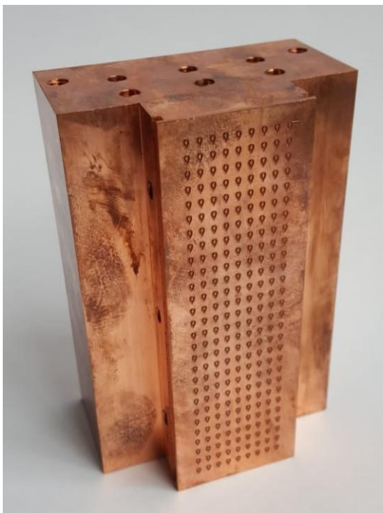
Σχήμα 4.32 : Τελικό δοκίμιο με χάραξη Piranha
