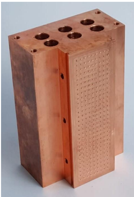
Σχήμα 4.40 : Τελικό δοκίμιο με χάραξη Piranha
