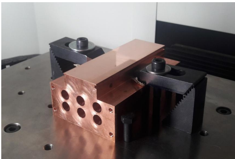
Σχήμα 4.12 : Το δοκίμιο κατάλληλα δεμένο στο τραπέζι της μηχανής προς χάραξη
