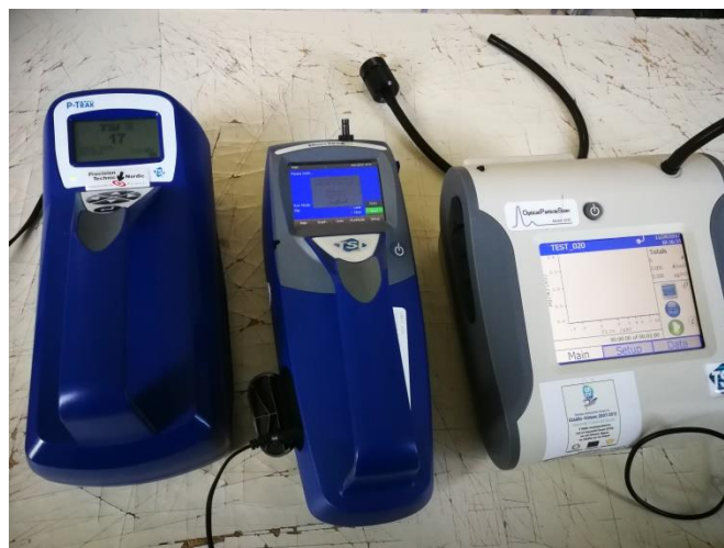
Εικόνα 9: Όργανα μέτρησης αιωρούμενων σωματιδίων που χρησιμοποιούν την μέθοδο της σκέδασης ακτινοβολίας.
