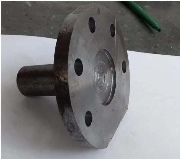
Σχήμα 3.1: Φλάντζα διάταξης μετά την ολοκλήρωση των κατεργασιών
