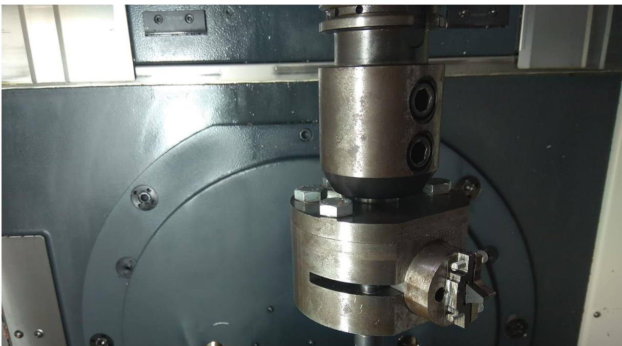
Σχήμα 4.14: Συγκράτηση πλήρους διάταξης μανέλας HOB
