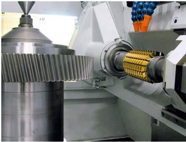
Σχήμα 2.16:Κινηματική κατεργασίας φραιζαρίσματος με κύλιση οδοντώσεων
