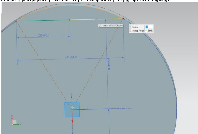
Σχήμα 3.11: Δημιουργία τόξων για αφαίρεση της απαραίτητης γεωμετρίας
