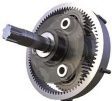
Σχήμα 2.6: Πλανητικό σύστημα
