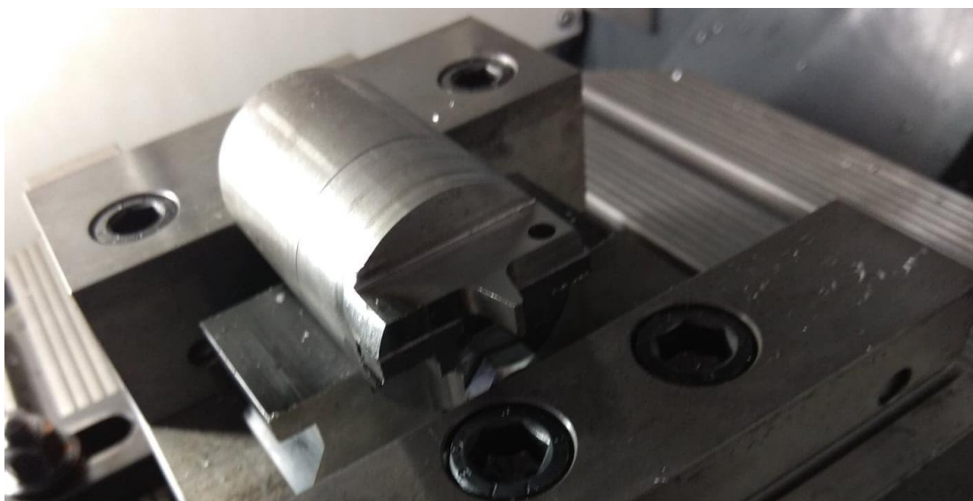
Σχήμα 3.68: Συγκράτηση μανέλας-λάμας για ταυτόχρονη διάνοιξη οπών
