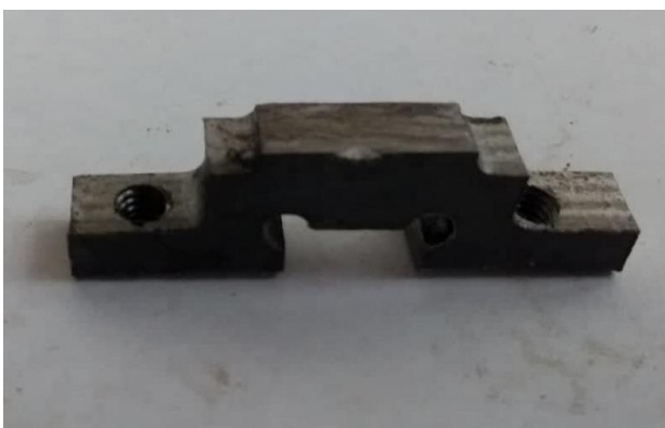
Σχήμα 3.59: Τελική μορφή λάμας μετά την ολοκλήρωση των κατεργασιών
