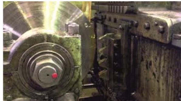
Σχήμα 2.13: Κατεργασία πλάνισης με κύλιση με οδοντωτό κανόνα
