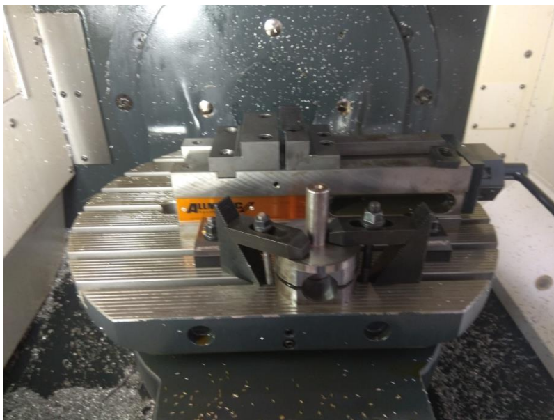
Σχήμα 3.36: Συγκράτηση φλάντζας-σώμα κυλίνδρου για ταυτόχρονη διάνοιξη οπών
