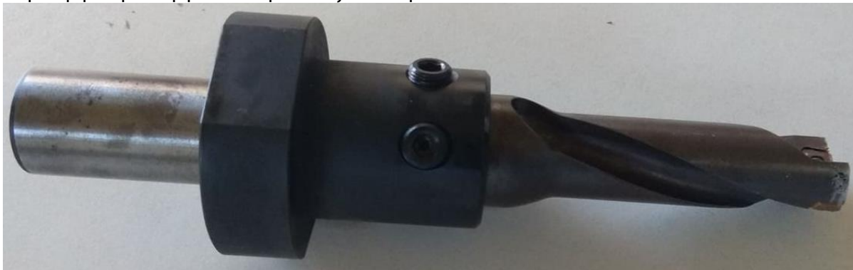
Σχήμα 3.19:Εργαλείο διάτρησης BORINGTOOL
