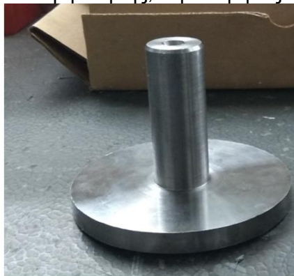
Σχήμα 3.18: Σύνταξη G κώδικα (αριστερά) για τη δημιουργία του άξονα της φλάντζας (δεξιά)
