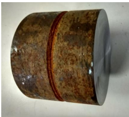
Σχήμα 3.31: Καθαρισμός με κατεργασία Facing στα δύο πρόσωπα του κυλίνδρου
