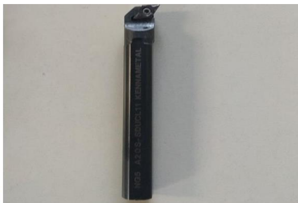
Σχήμα 3.20: Σύνταξη G κώδικα για τη κατεργασία εσωτερικής τórνευσης και δημιουργία θηλυκής εσοχής (αριστερά) και μανέλα εσωτερικής τórνευσης (δεξιά)
