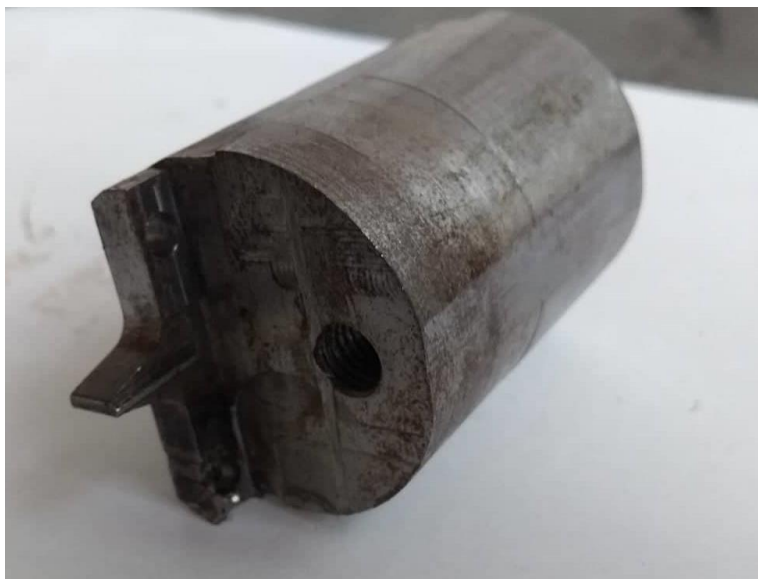
Σχήμα 3.38: Μανέλα συγκράτησης κοπτικού εργαλείου
