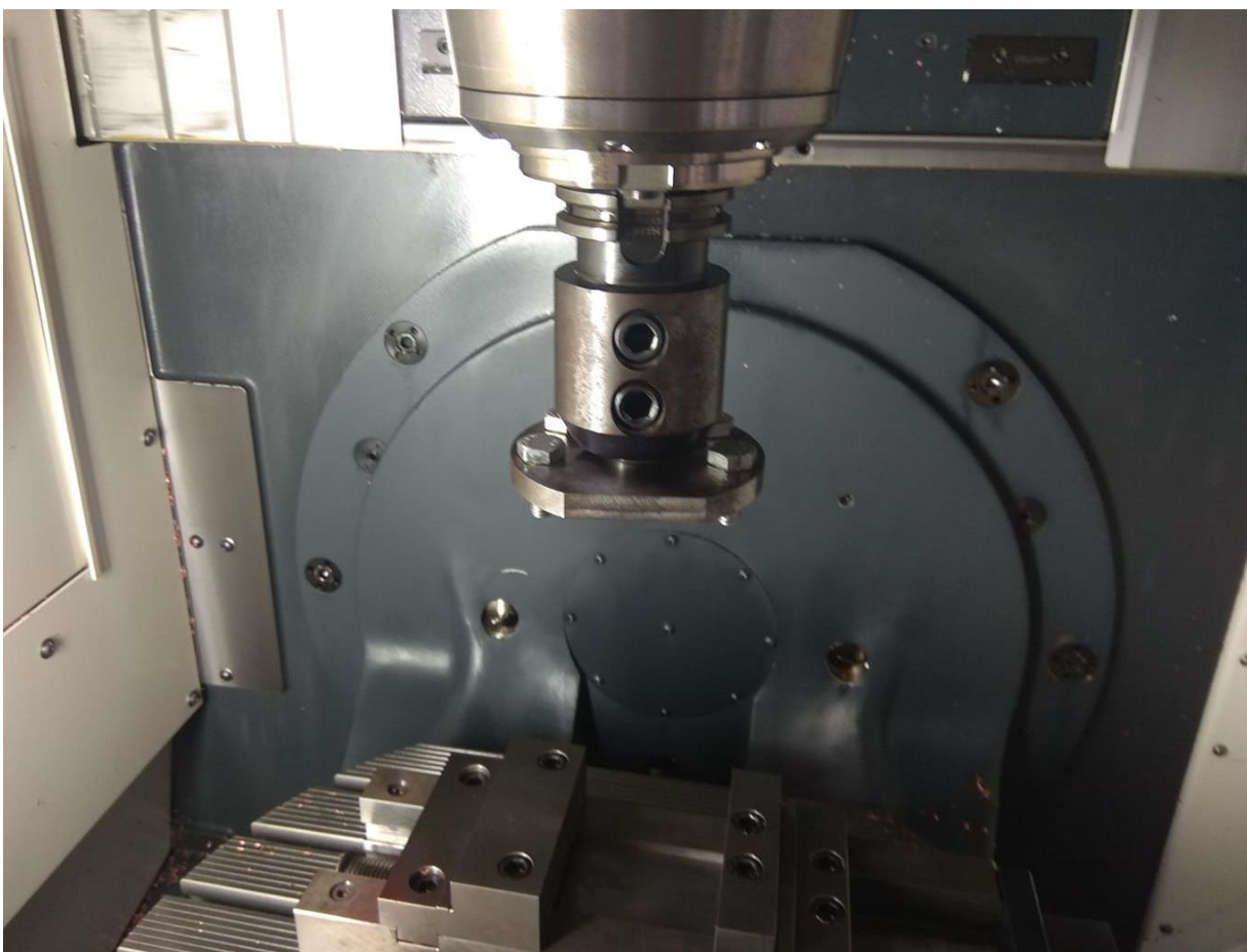
Σχήμα 4.13: Συγκράτηση διάταξης φλάντζας- κωνικού τσοκ συγκράτησης στο κέντρο κατεργασιών
