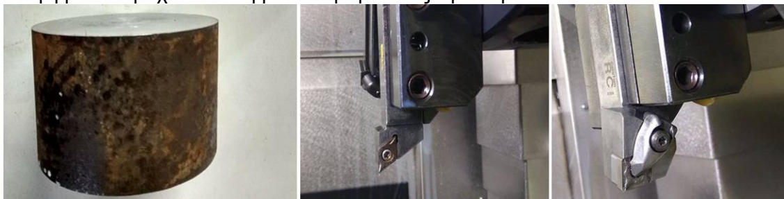
Σχήμα 3.15: Καθαρισμός προσώπου τεμαχίου (αριστερά) με εργαλείο εκχόνδρισης (δεξιά) και εργαλείο φινιρίσματος (μέση)
