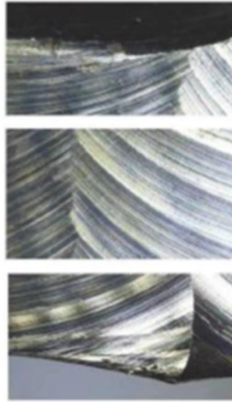
Σχήμα 5.31 : Τελικά επιφάνεια ανοξείδωτου χάλυβα κατά την ξηρή και κρυογενική κατεργασία του.
