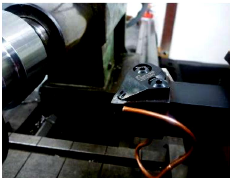
Σχήμα 3.6 : Διανομή κρυογενικού ψυκτικού μέσω ακροφυσίου στην πρόσδεση του κοπτικού, σε κατεργασία τόννευσης
