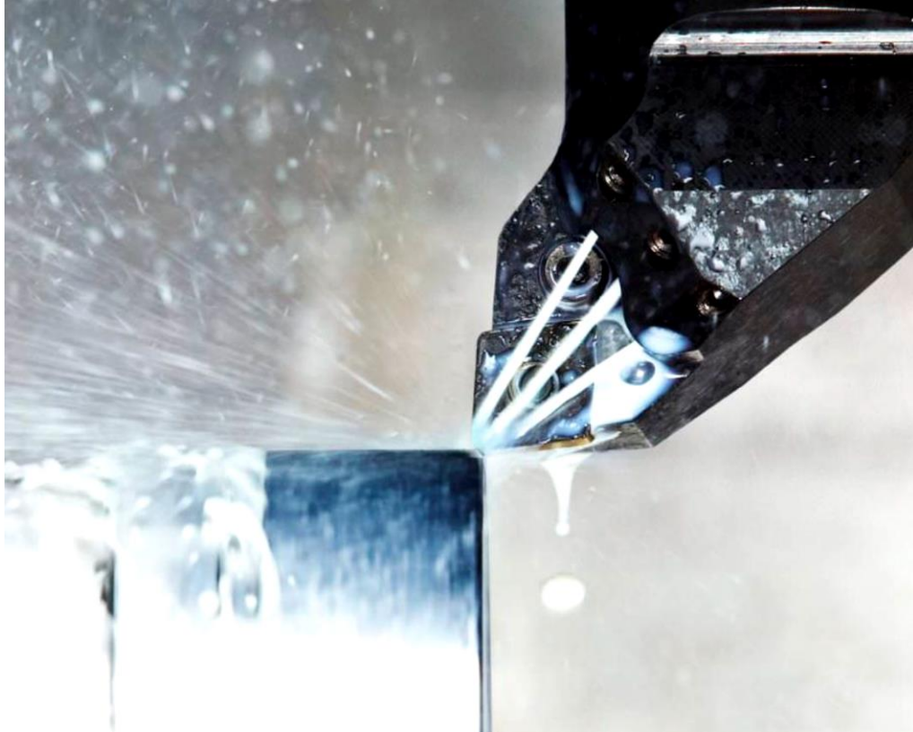
Σχήμα 2.1 : Συμβατική Τórνευση με χρήση γαλακτώματος σαπουνέλαιου.
