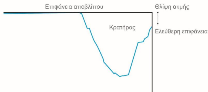
Σχήμα 5.9 : Το προφίλ του κρατήρα του κοπτικού που επεκτείνει την κοπτική ακμή κατά την κρυογενική τόννευση του κράματος Ti-6Al-4V [42].
