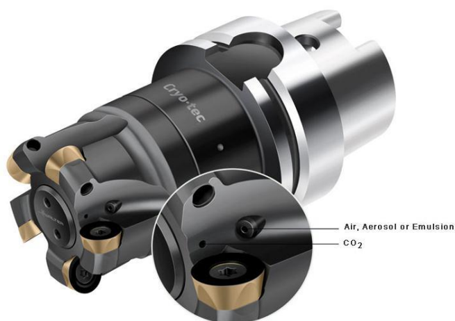
Σχήμα 6.1 : Κοπτικό εργαλείο φραιζας εφοδιασμένο με μονωμένο αγωγό για παροχή CO 2 και πεπιεσμένου αέρα.
