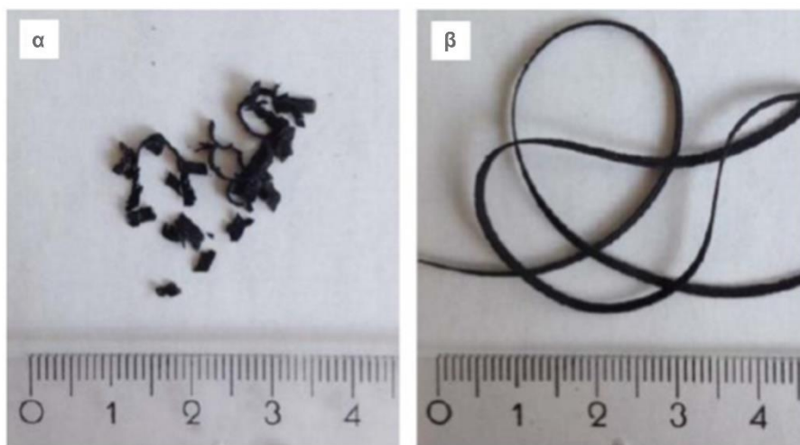
Σχήμα 5.25: Μορφή παραγόμενου αποβλίπτου κατά την κρυογενική (α) και κατά την ξηρή (β) του τόννευση.
