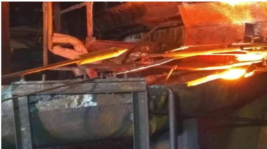
Εικόνα 1.4. Ρευστή σκωρία στη φάση της αποσκωρίωσης του τμήματος Π2.
