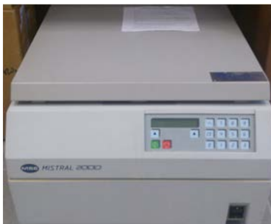
Εικόνα 3.3 Η φυγόκεντρος όπου πραγματοποιείται ο διαχωρισμός του στερεού μέσω εκπλύσεων με δις απιονισμένο νερό και τελική έκπλυση με αιθανόλη.
