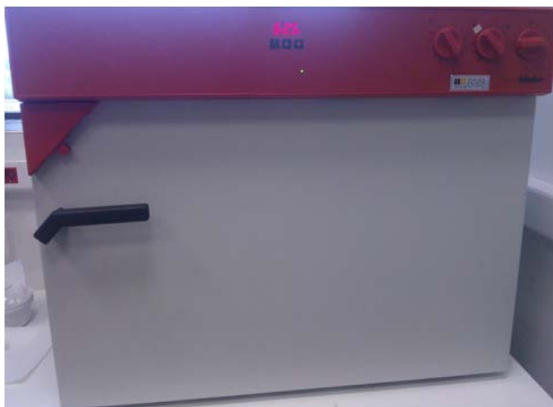
Εικόνα 3.1 Ο φούρνος όπου πραγματοποιείται η γήρανση του υδατικού διαλύματος ( \text{Ce}(\text{NO}_3)_3 \cdot 6\text{H}_2\text{O} και \text{NaOH} ) στους 90°C για 24 ώρες.
