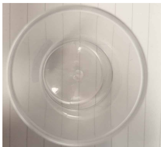
Εικόνα 4.10 Xerogel του STP-Γns, απαλλαγμένο από μικρορωγμές [4]
