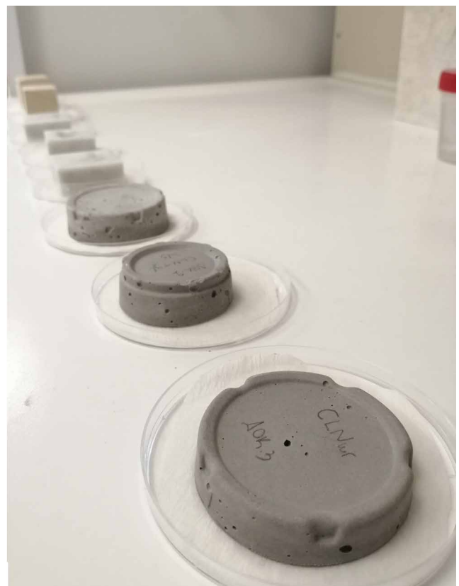
Εικόνα 3.12 Τριχοειδής αναρρίχηση διαφόρων δοκιμίων στα πρώτα λεπτά (αριστερά) και στις 48 ώρες (δεξιά) [4]
