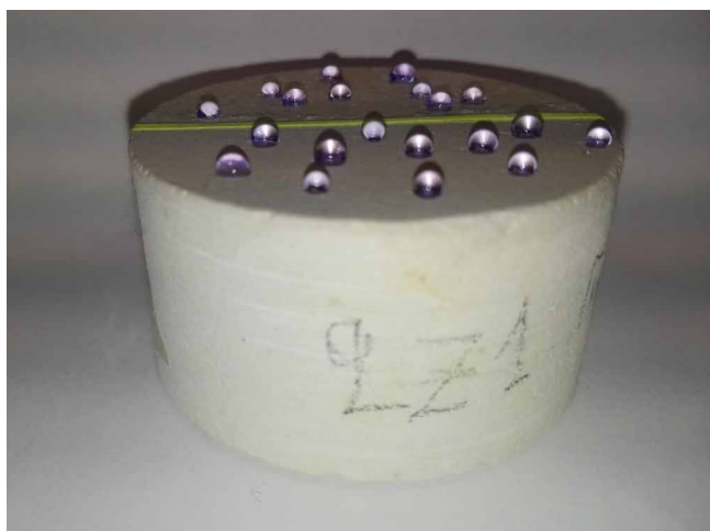
Εικόνα 2.6 Συμπεριφορά σταγονιδίων νερού σε επιφάνεια που έχει επικαλυφθεί με επίστρωση νανοςωματιδίων [4]
