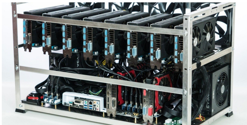
Εικόνα 2.9: Απαιτούμενο σύστημα για την υλοποίηση του αλγορίθμου Dagger - Hashimoto. https://cryptosrus.com/ethereum-mining-rig/ (15/3/2019)
