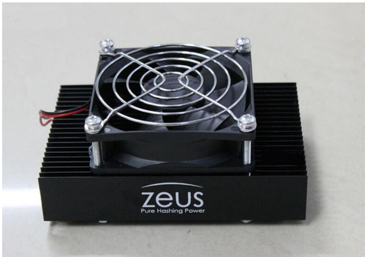
Εικόνα 2.7: Σύστημα υλοποίησης Mining, της εταιρίας Zeus Integrated Systems Limited, για τον αλγόριθμο Scrypt. https://cryptomining-blog.com/tag/zeusminer-blizzard-review/ (25/3/2019)
