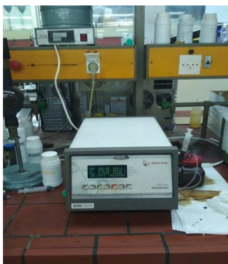
Εικόνα 6.1: Ιξωδόμετρο Stabinger SVM 3000 του Εργαστηρίου Καυσίμων και Λιπαντικών του Εθνικού Μετσόβιου Πολυτεχνείου.
