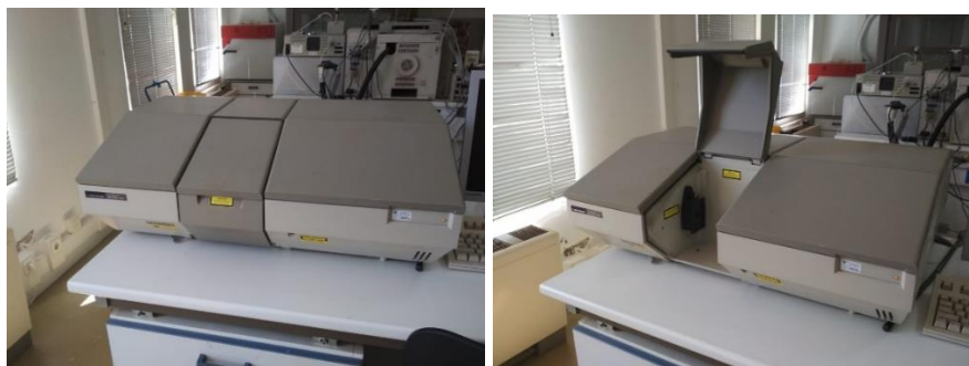
Εικόνα 6.2: Όργανο υπέρυθρης φασματοσκοπίας μετασχηματισμού Fourier (FTIR) του Εργαστηρίου Ανάλυσης Πυρήνων και Υπόγειων Ταμιευτήρων του Πολυτεχνείου Κρήτης.
