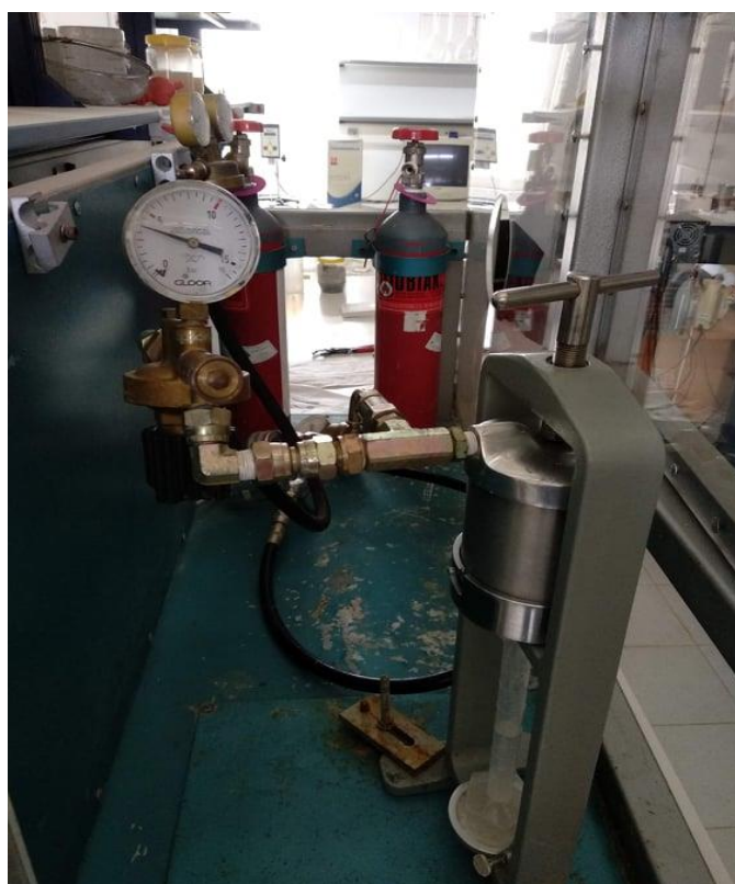
Εικόνα 3.10: Φιλτρόπρεσα LPLT της εταιρείας FANN (πηγή: Φωτογραφίες Διπλωματικής)
