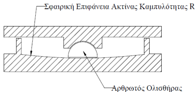
Σχήμα 6.7: Τυπική διάταξη ενός FPS συστήματος.
