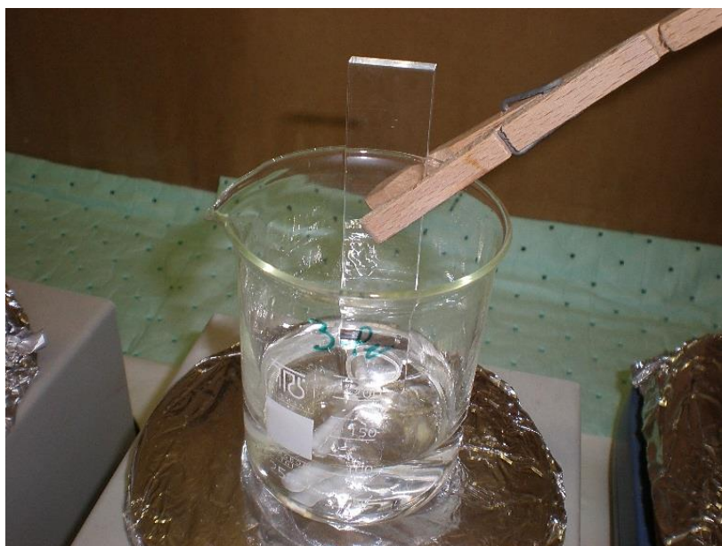
Σχήμα 42. Συσκευή αυθόρμητης εναπόθεσης πολωνίου.
