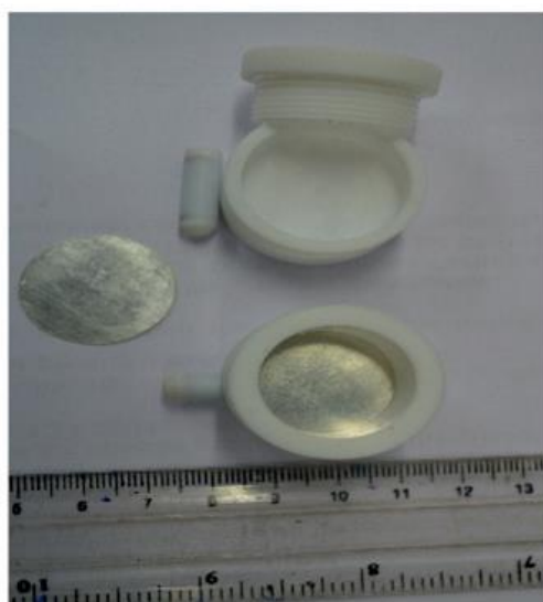
Σχήμα 43. Συσκευή αυθόρμητης εναπόθεσης πολωνίου με προσαρμοσμένο μαγνήτη [161].
