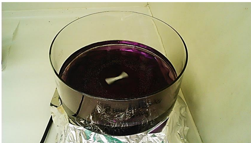
Σχήμα 86. Μεμβρανική συμπλοκοποίηση ουρανίου υπό συνεχή ανάδευση, σε όγκο δείγματος 0.5L και για χρόνο επαφής μίας ημέρας.
