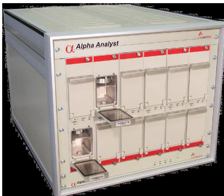
Σχήμα 48. Θάλαμοι α-φασματοσκοπίας στους οποίους εφαρμόζεται κενό και συνδέονται με τα ηλεκτρονικά μέρη του συστήματος [178].
