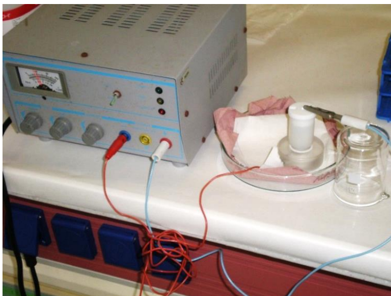
Σχήμα 38. Συνήθης διάταξη ηλεκτρόλυσης ραδιονουκλιδίων.
