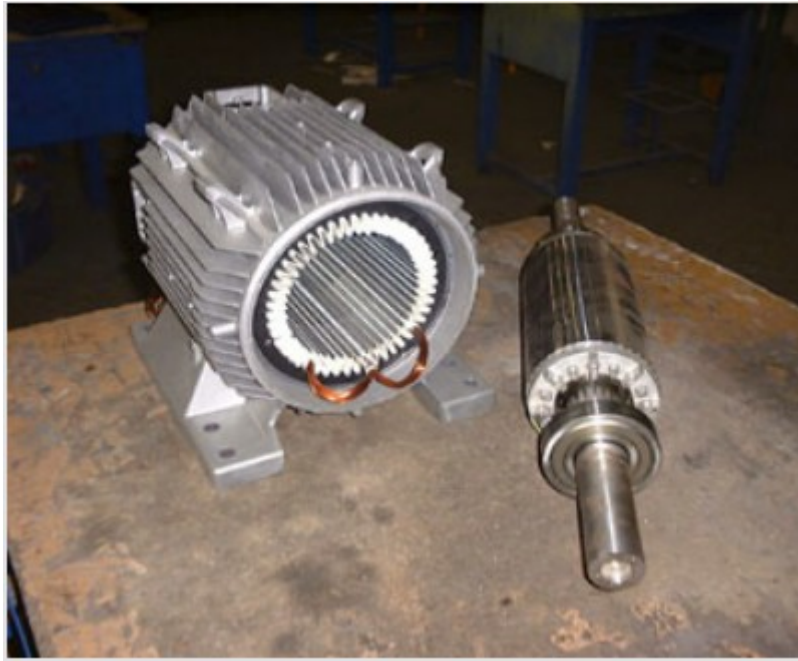
Σχήμα 3.4: Εσωτερικό ασύγχρονου κινητήρα στην οποία διακρίνονται όλα τα δομικά του στοιχεία.
