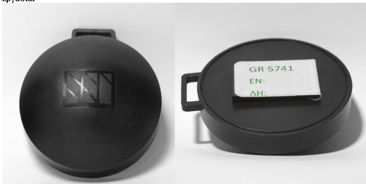
Εικόνα 20: Παθητικός ανιχνευτής πυρηνικών ιχνών CR-39 που χρησιμοποιήθηκε στην παρούσα εργασία.
