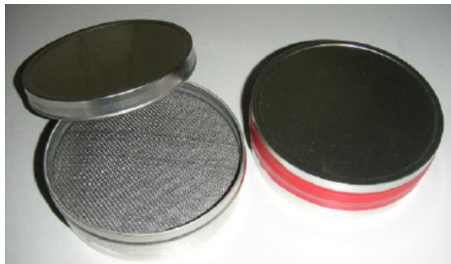
Εικόνα 11: Ανοιγμένο δοχείο ενεργού ξυλάνθρακα (αριστερά) & κλειστό δοχείο ενεργού ξυλάνθρακα (δεξιά). (Πηγή: https://www.researchgate.net/figure/239815223_fig1_Figure-1-Photograph-showing-two-activated-charcoal-canisters-The-opened-canister-shows )
