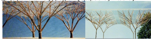
Εικ. 5.12: Αριστερά: Ανεστραμμένο μοντέλο κρεμαστών βρεγμένων κλωστών που έχει σκληρυνθεί χρησιμοποιώντας πολυεστέρα. Δεξιά: Μακέτα στεγάστρου διακλαδωτής κατασκευής.
