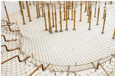
Εικ. 4.14: Το μοντέλο κρεμαστών αλυσίδων του Multihalle.
