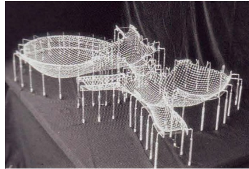
Εικ. 4.15: Το μοντέλο κρεμαστών αλυσίδων του Multihalle.
