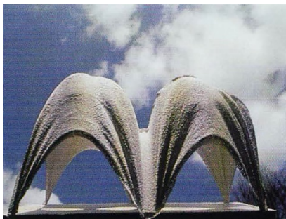
Εικ. 4.2: Αναπαράσταση θολωτών μορφών με τη βοήθεια γυψόγαζων.
