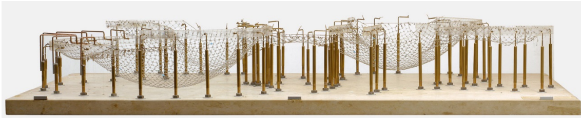
Εικ. 4.12: Το μοντέλο κρεμαστών αλυσίδων του Multihalle.
