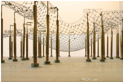
Εικ. 4.13: Το μοντέλο κρεμαστών αλυσίδων του Multihalle.
