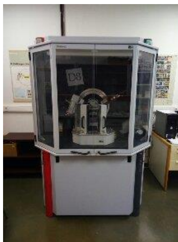
Εικόνα 9: Περιθλασίμετρο ακτίνων – X (XRD) του εργαστηρίου Γενικής και Τεχνικής Ορυκτολογίας του Πολυτεχνείου Κρήτης.
