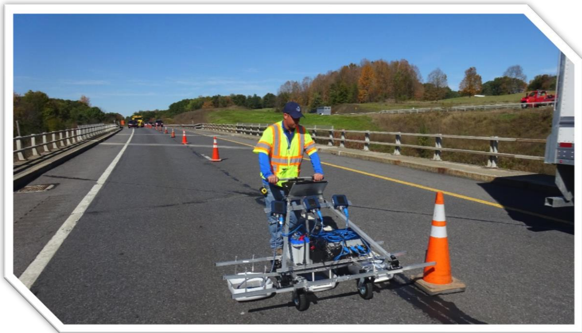
Εικόνα 1.2: Μη καταστροφικός έλεγχος ποιότητας του οδοστρώματος ( https://www.infrastructurepc.com/subsurface-mapping-with-ground-penetrating-radar/ )
