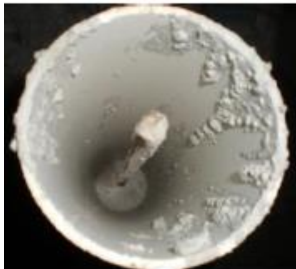
Εικόνα 2.3: Αναλυτική παρουσίαση του πλαστικού σωλήνα PVC που προσομοιώνει το κατασκευαστικό κενό (Ελένη Χειλάκου, 2015 https://repository.kallipos.gr/bitstream/11419/6172/2/01_chapter_4.pdf )
