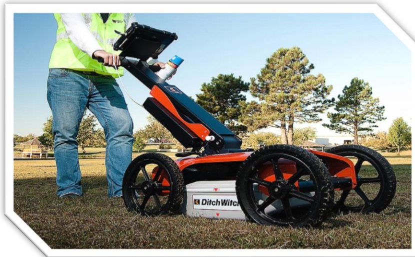
Εικόνα 1.1: Επίγειο διεξοδυτικό ραντάρ που χρησιμοποιείται κοντά στο Stillwater, Οκλαχόμα ( https://en.wikipedia.org/wiki/Ground-penetrating_radar )
