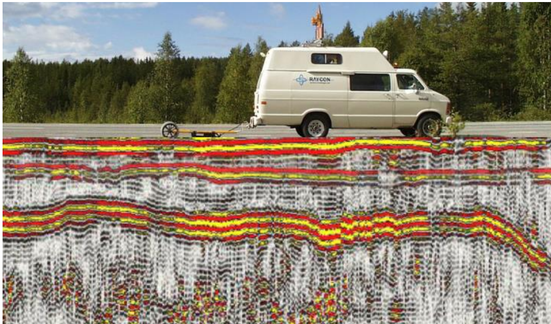
Εικόνα 1.9: Αποτίμηση ποιότητας ασφάλτου με χρήση γεωραντάρ (πηγή Γεωραντάρ, Ανδρέας Τζανής- http://users.uoa.gr/~atzanis/Y7203/GPR_Supporting_Material/GPR_no_animation.pdf )
