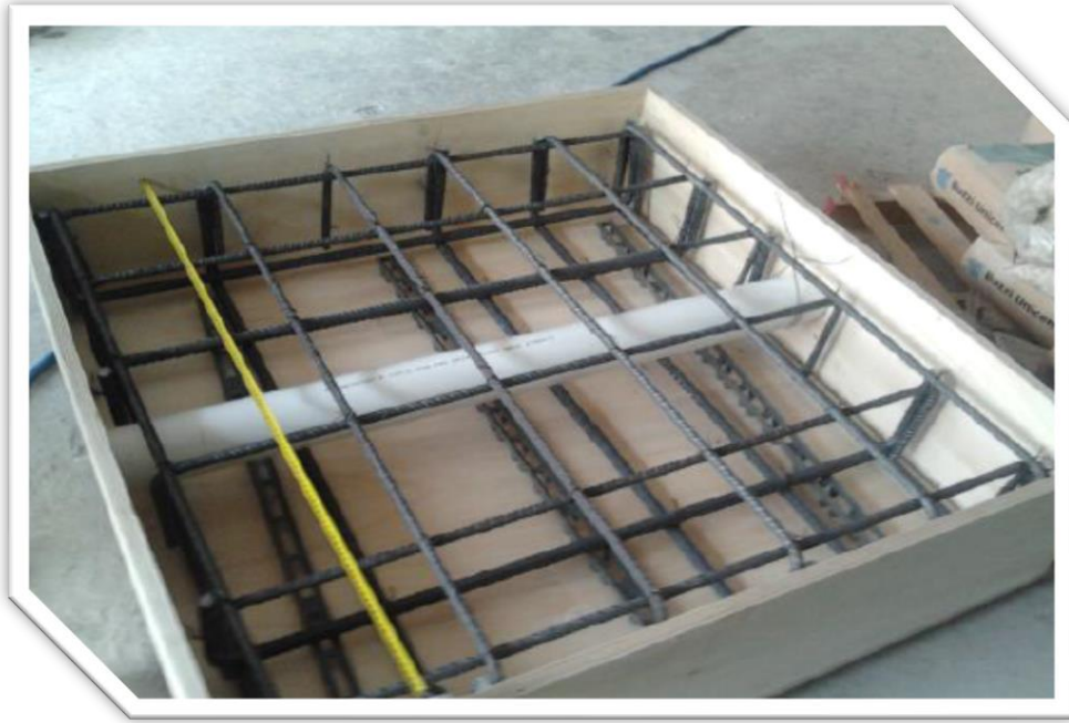
Εικόνα 2.2: Θέση οπλισμού μέσα στην δειγματική πλάκα και σωλήνα τύπου PVC (Ελένη Χειλάκου, 2015 https://repository.kallipos.gr/bitstream/11419/6172/2/01_chapter_4.pdf )
