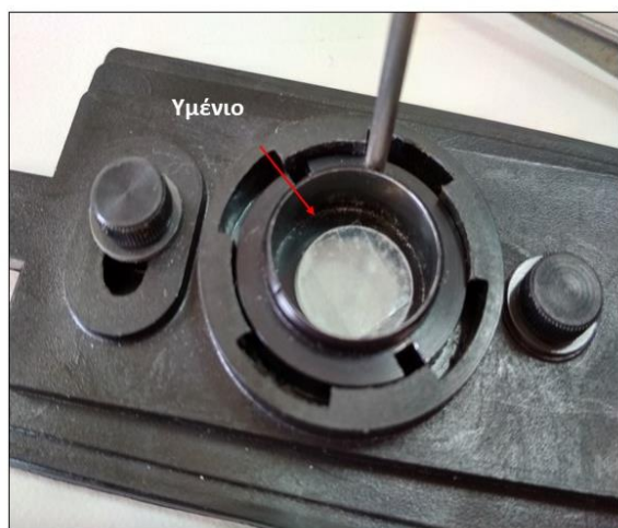
Εικόνα 37 : Γυμένιο τοποθετημένο σε δισκίο βρωμιούχου καλίου πάνω στον δειγματοφορέα στα αριστερά, και 2 δισκία βρωμιούχου καλίου στα δεξιά
