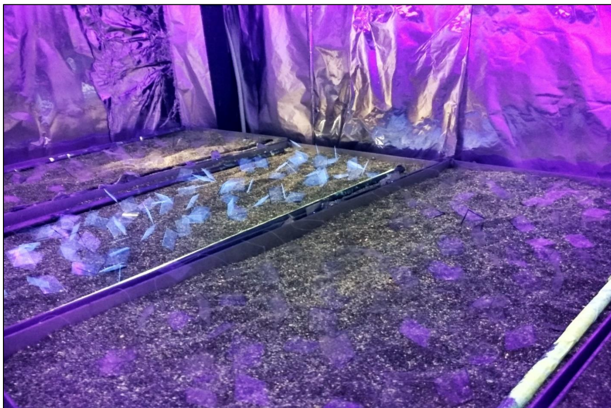
Εικόνα 29 : Έκθεση πλαστικών υμενίων σε UV ακτινοβολία
