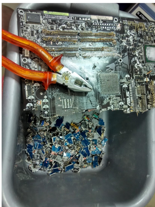
Εικόνα 9. Τεμαχισμός πλακέτας
