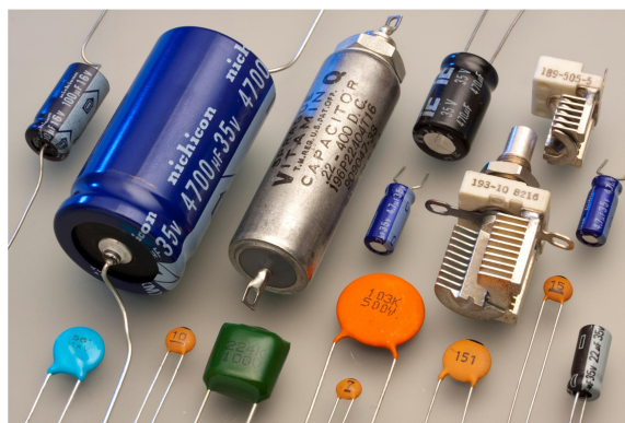
Εικόνα 4. Πυκνωτές διάφορων ειδών (Capacitors) ( https://creativecommons.org/licenses/by-sa/2.5 )
