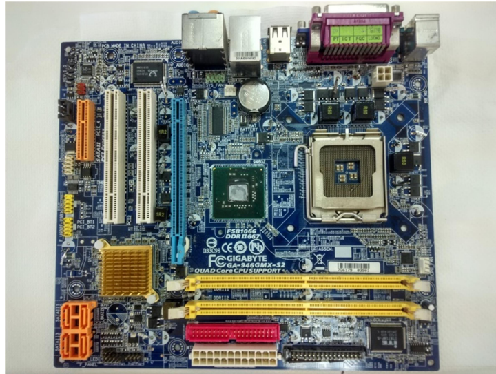
Εικόνα 7. Η πλακέτα PCB που χρησιμοποιήθηκε στη μελέτη (GIGABYTE GA-946GMX-S2)
