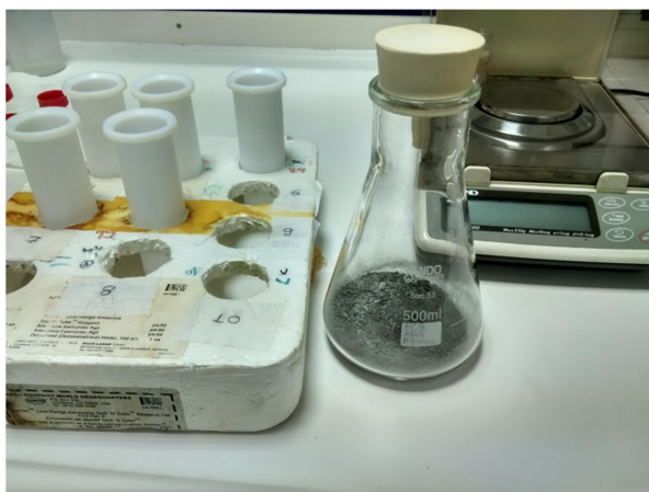
Εικόνα 16. Η PCB σε μορφή πούδρας για την ολική διαλυτοποίηση
