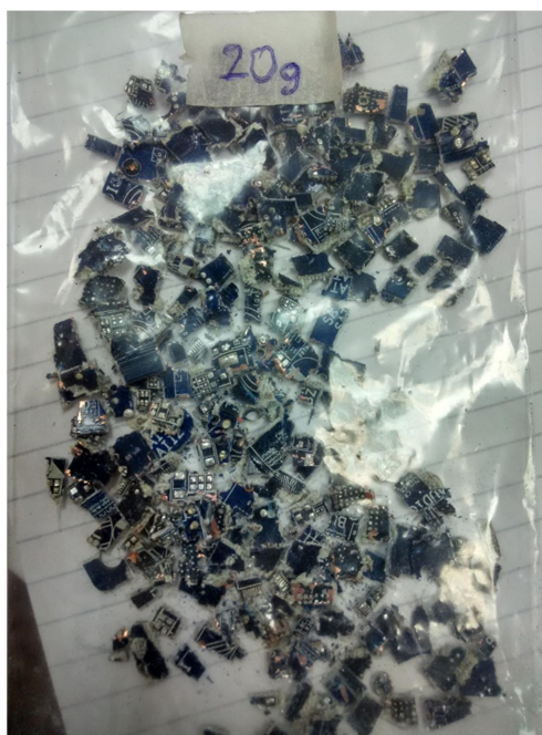
Εικόνα 10. Τεμαχισμένα PCB, σε μέγεθος X2 (0,5 x 1 cm 2 )
