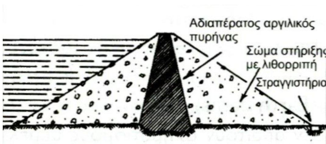
Σχήμα 1.4: Λιθόρριπτο φράγμα με κατακόρυφο αργιλικό πυρήνα (Κούκης, Σαμπατακάκης, 2007).
