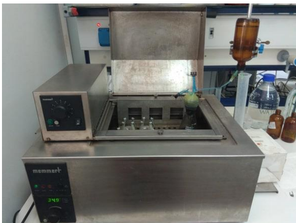
Εικόνα 7: Βύθιση αντιδραστήρων σε υδατόλουτρο και ογκομέτρηση μεθανίου με διάλυμα NaOH
