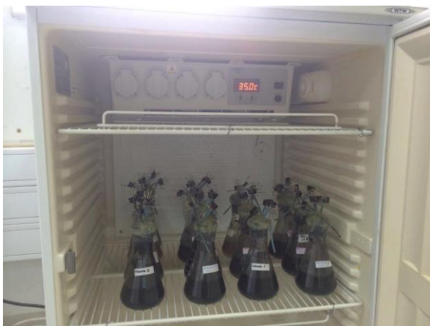
Εικόνα 8 : Αναερόβια χώνευση των αντιδραστήρων εντός του επωαστήρα
