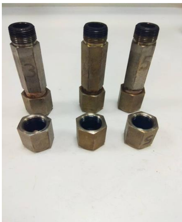
Εικόνα 11: Αντιδραστήρες για την υδροθερμική επεξεργασία
