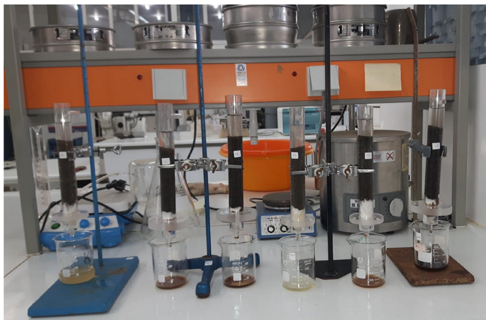
Εικόνα 3.5 Διαδικασία συλλογής εκπλυμάτων σε γυάλινα ποτήρια ζέσεως.
