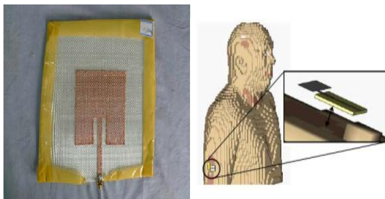
Σχήμα 3.4. «Υφαντή» κεραία τύπου μικροταινίας (microstrip patch antenna) τοποθετημένη στον ώμο [Kaur, 2014]
