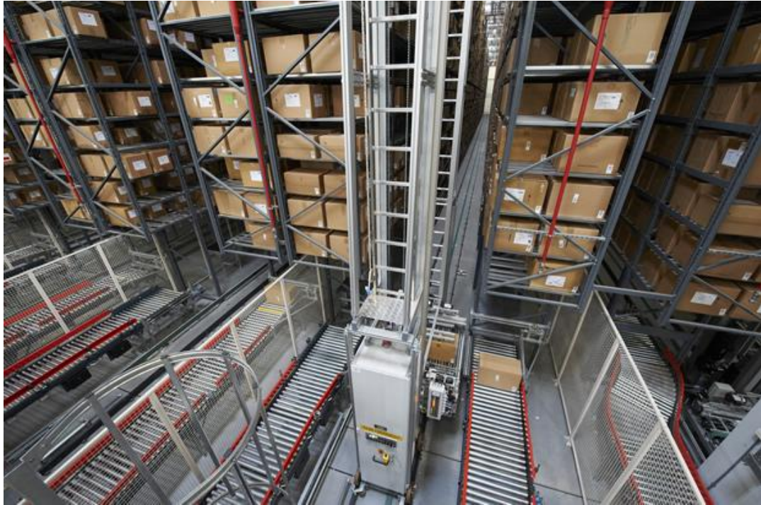
Εικόνα 8: ΡΑΦΙΑ-ΓΕΡΑΝΟΣ-ΔΙΑΔΡΟΜΟΙ ΣΕ AS/RS SYSTEM
