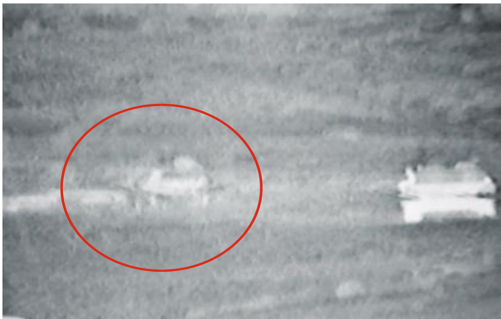
Άρματα μάχης Leopard, με επικάλυψη αντι θερμικής βαφής και με κοινή βαφή αντίστοιχα
