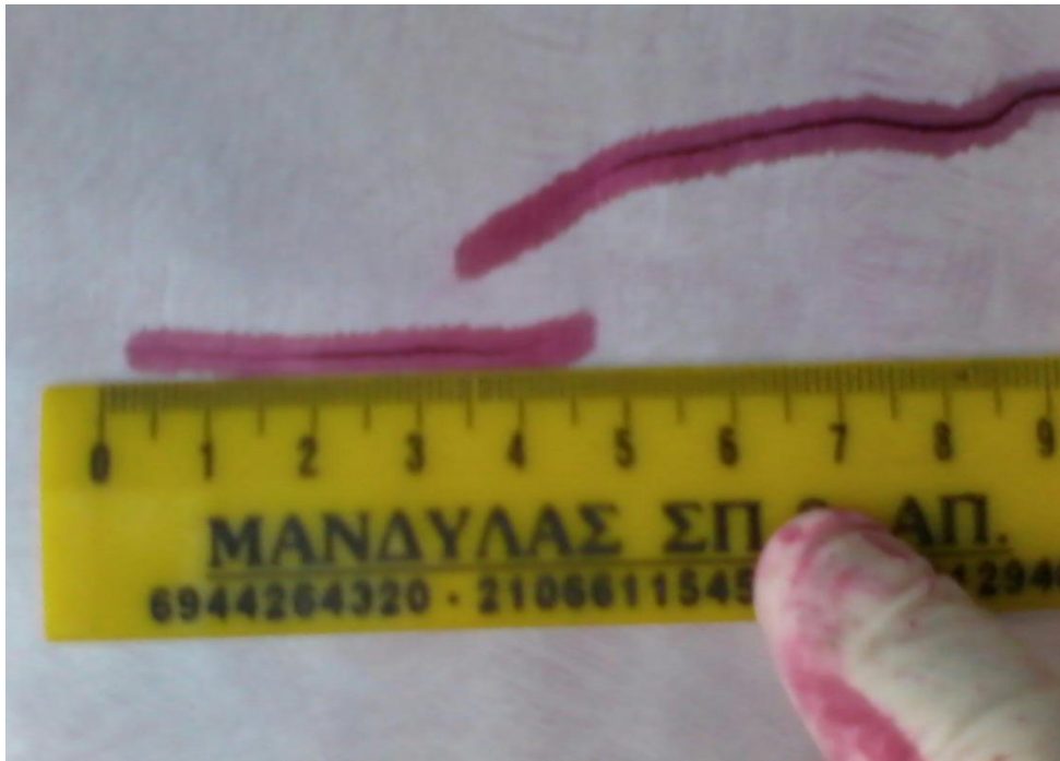
Φωτογραφία 36. Ανάπτυγμα διεισδυτικών υγρών
