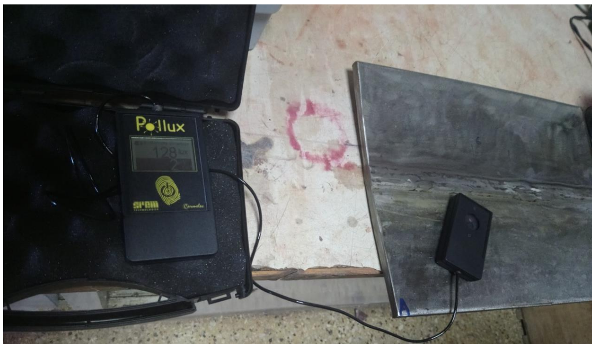
Φωτογραφία 22. Φωτόμετρο - Μετράει τον φωτισμό στην περιοχή εξέτασης
