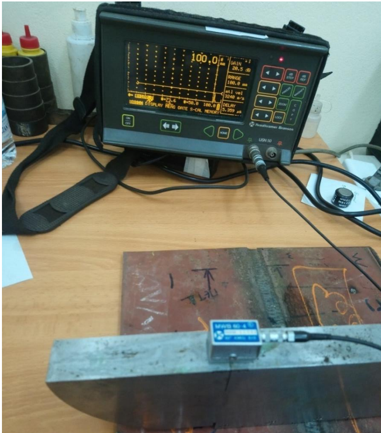
Φωτογραφία 18. Ψηφιακό όργανο υπερήχων, κεφαλή δέσμης, τεμάχιο υπό δοκιμή.
