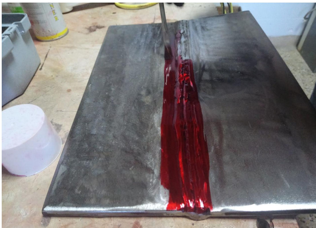
Φωτογραφία 30. Εφαρμογή διεισδυτή κατά τον έλεγχο με διεισδυτικά υγρά
