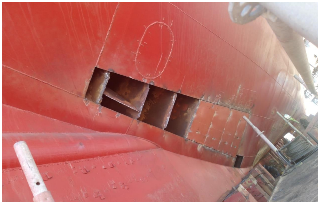
Φωτογραφία 44. Τμήματα συγκολλήσεων προς έλεγχο κατά την διαδικασία επισκευής πλοίου
