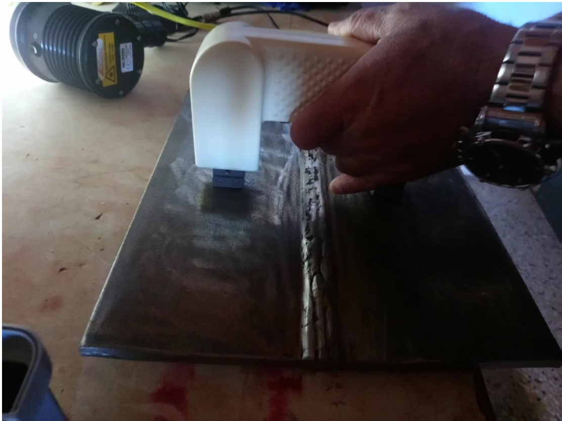
Φωτογραφία 24. Συσκευή μαγνητικού ελέγχου πάνω σε πρότυπο δοκίμιο 4Kgr
