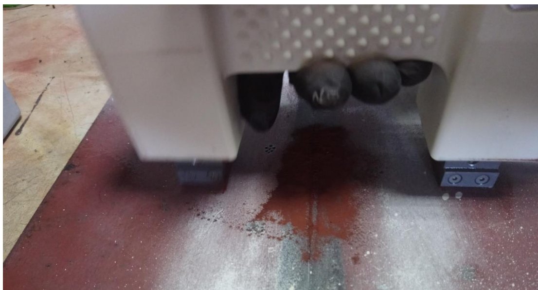
Φωτογραφία 28. Εφαρμογή μαγνητικών πεδίου με χρήση σκόνης με ψήγματα σιδήρου κόκκινου χρώματος
