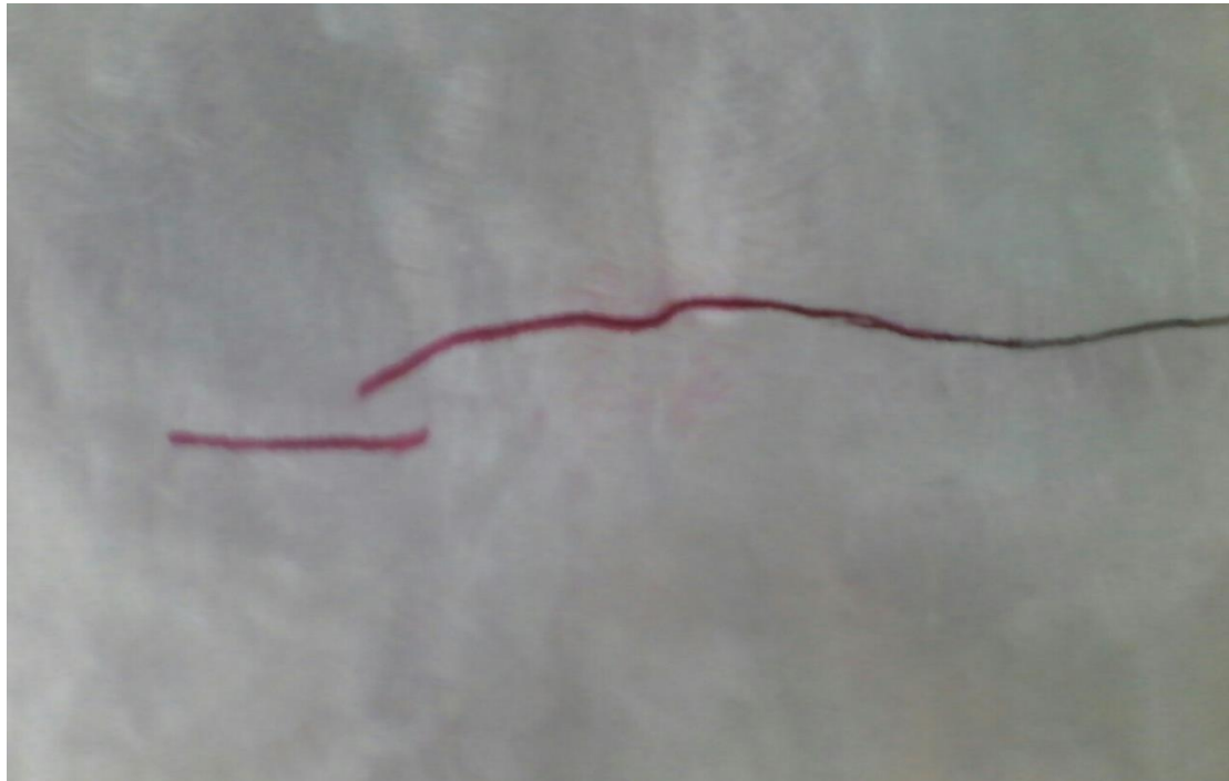
Φωτογραφία 37. Ανάπτυγμα διεισδυτικών υγρών
