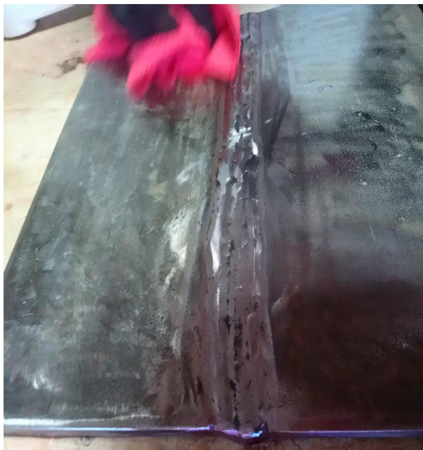
Φωτογραφία 31. Καθαρισμός επιφάνειας μετά την εφαρμογή του διεισδυτή
