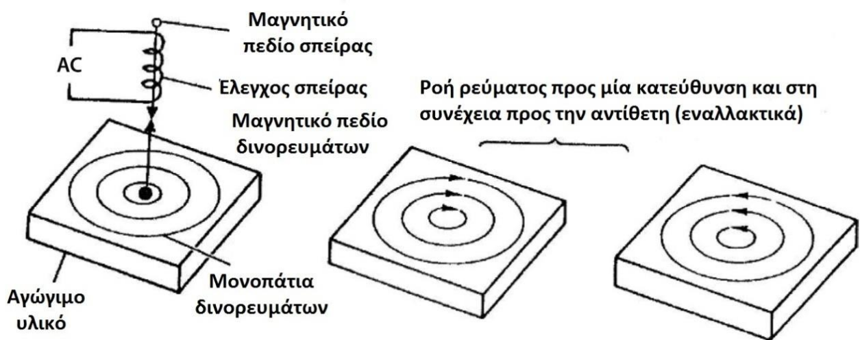
Εικόνα 6. Ένα πρωτεύον πηνίο που προκαλεί δινορρεύματα σε ένα στοιχείο
