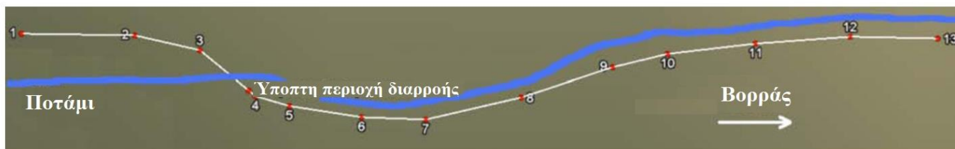
Σχήμα 44. Σχέδιο αγωγού με θέσεις αισθητήρων
