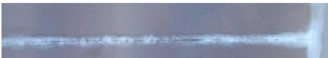
Φωτογραφία 16. Ανάγνωση ραδιογραφικού φιλμ με εμφανή την κατά μήκος αστοχία
