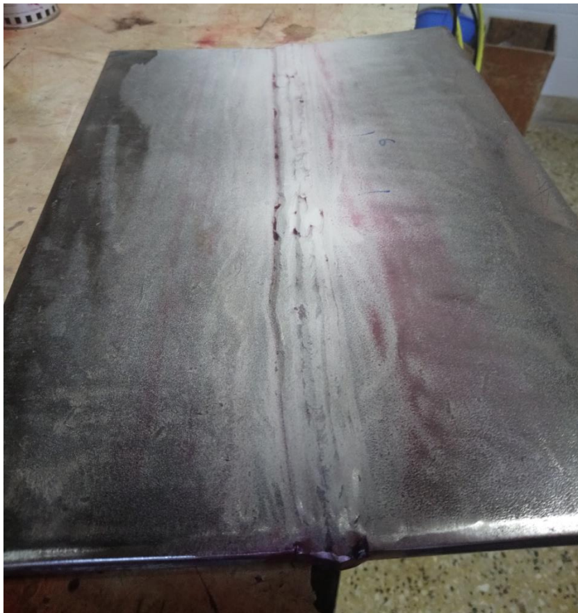
Φωτογραφία 32. Εφαρμογή του εμφανιστή (developer)
