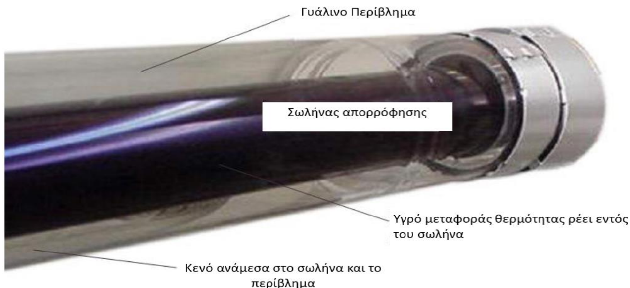
Εικόνα 2.2.1.1: Σωλήνας απορρόφησης με γυάλινο περίβλημα.
