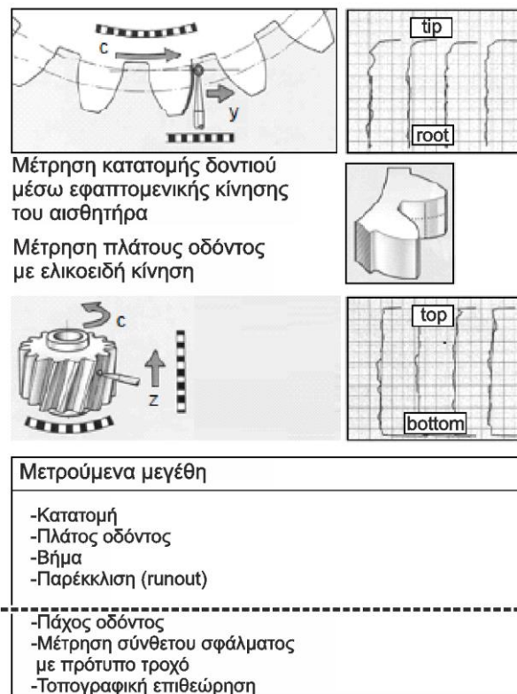
Σχήμα 4.5: Μεγέθη προς επιθεώρηση ενός οδοντωτού τροχού
