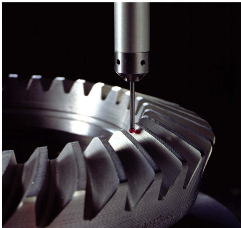
Σχήμα 4.2: Μηχανή Μέτρησης Συντεταγμένων (CMM)
