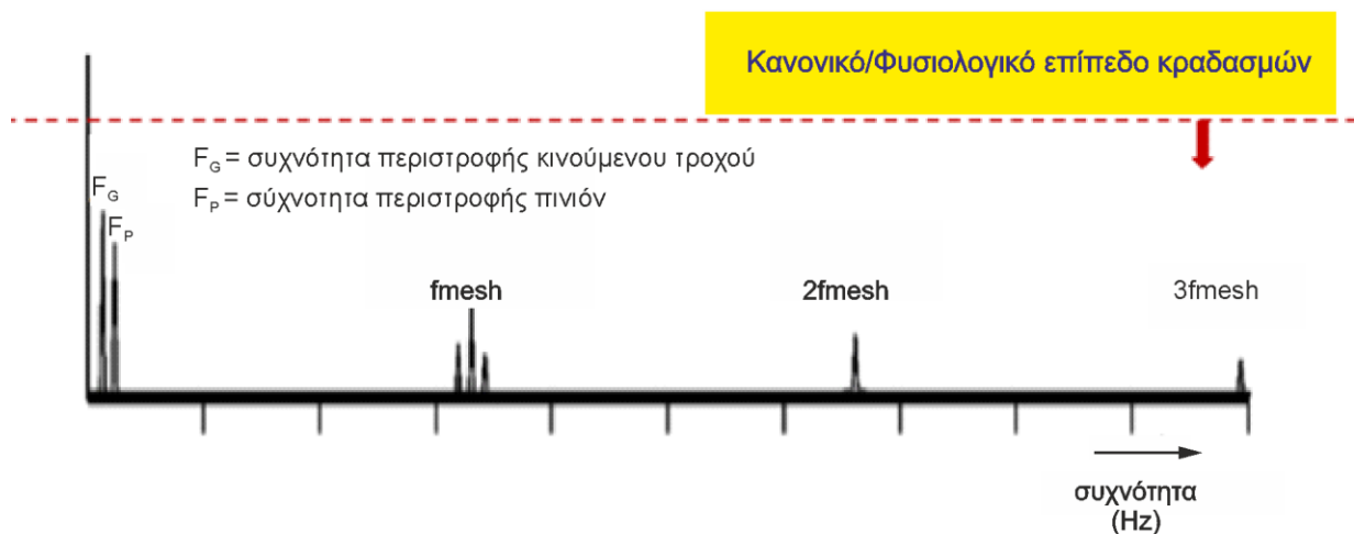
Σχήμα 3.17: Κανονική εμπλοκή οδοντωτών τροχών.
