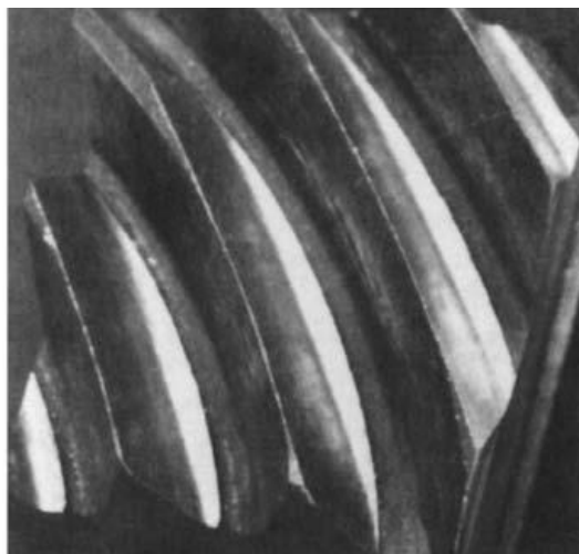
Σχήμα 3.12: Φθορά λόγω ύπαρξης ξένων σωματιδίων σε κωνικό οδοντωτό τροχό.
