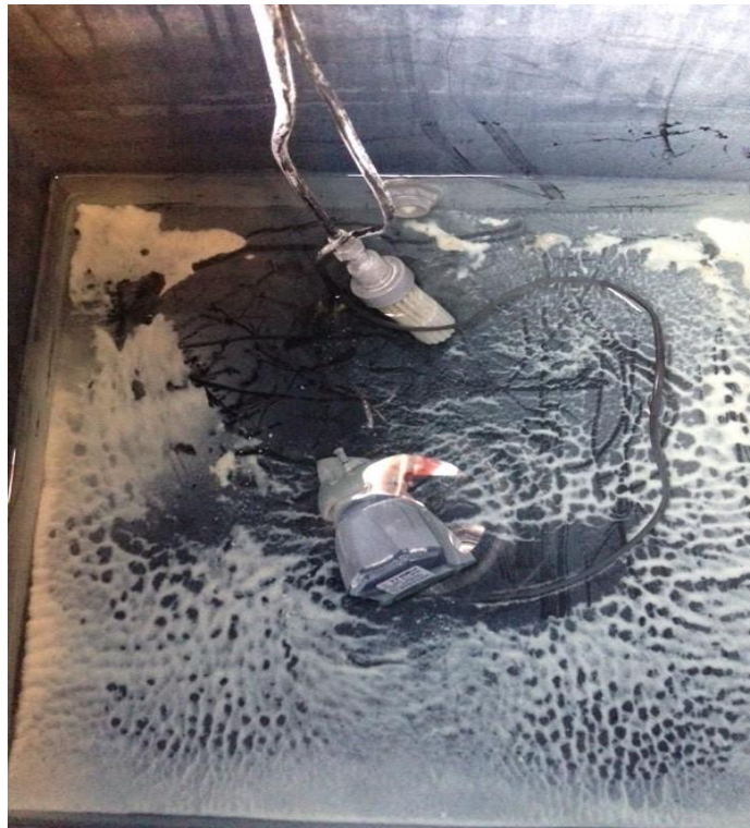
Εικόνα 19 Καθίζηση μετάλλων στην δεξαμενή επιμόλυνσης
