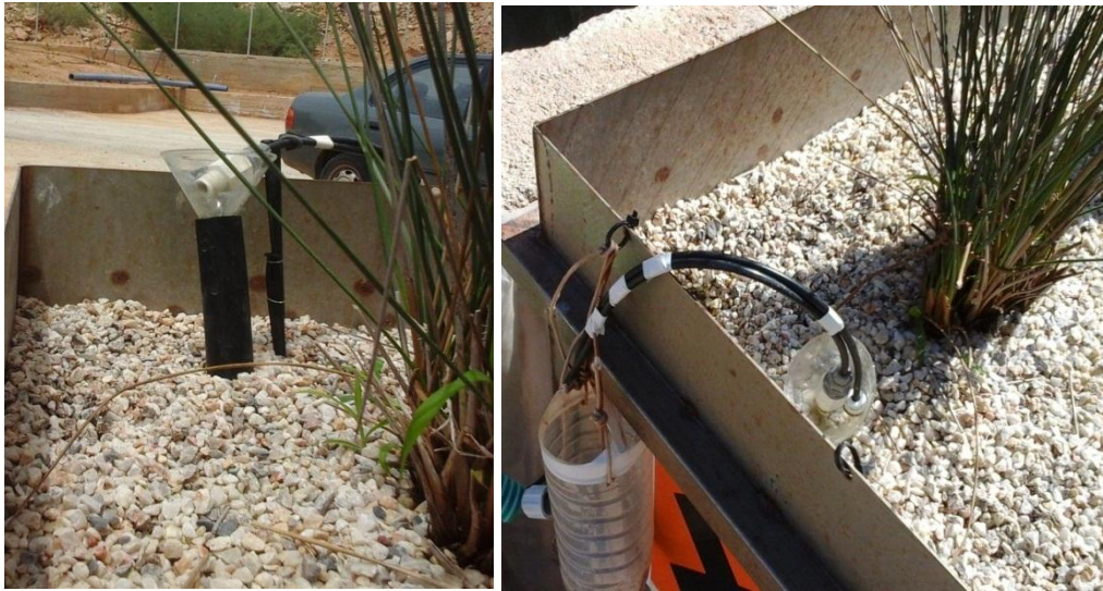
Εικόνα 13. Το σημείο ανάμειξης του λύματος και του επιμολυσμένου με ΒΜ νερού, στην είσοδο του υγροβιότοπου.
