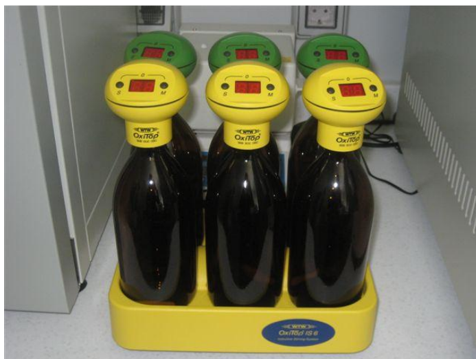
Εικόνα 17 Φιάλες BOD με τα ειδικά πώματα OxiTop ,τοποθετημένες πάνω στο σύστημα μαγνητικού αναδευτήρα
